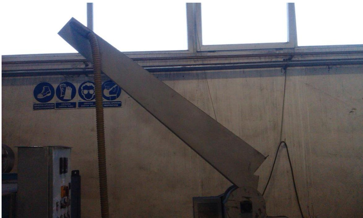
Slika 3-4. Prvi uređaj za recikliranje električnih žarulja
