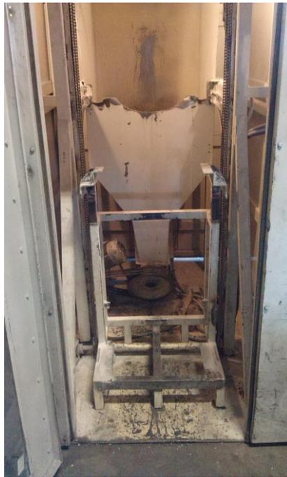
Slika 3-6. Automatski podizač spremnika u uređaj za recikliranje
