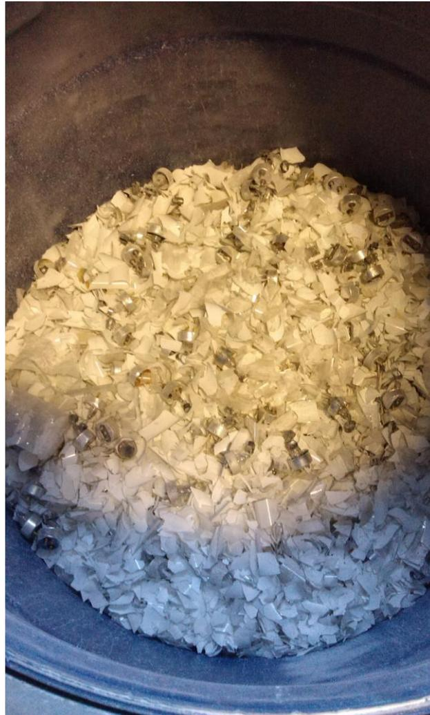
Slika 3-5. Spremnik sa zdrobljenim električnim žaruljama
