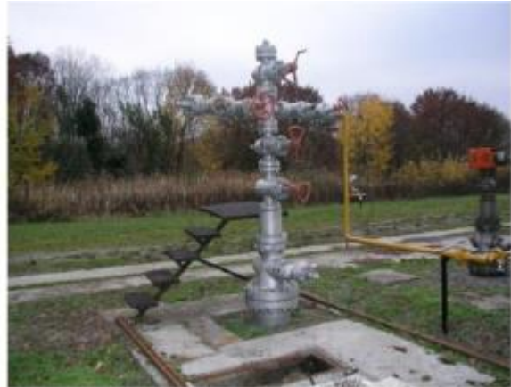
Slika 2-2. Naftna eruptivna i plinska eruptivna bušotina (Pletikapić et al., 2015)
