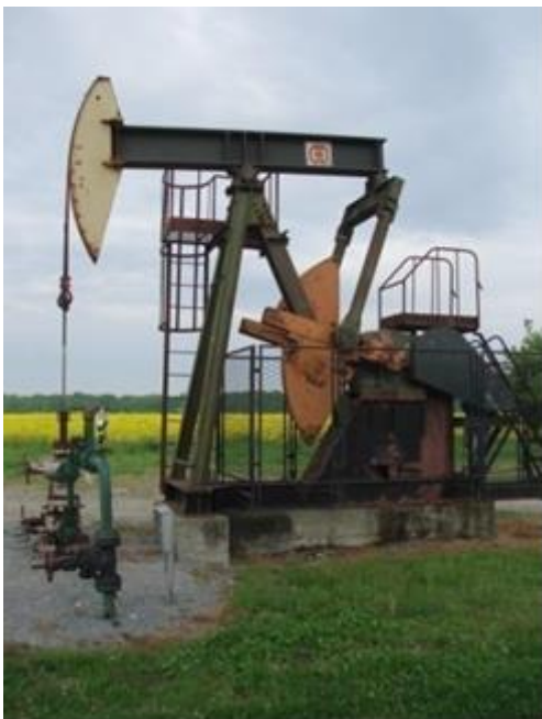
Slika 2-4. Naftna bušotina s dubinskom sisaljkom (Pletikapić et al., 2015)
