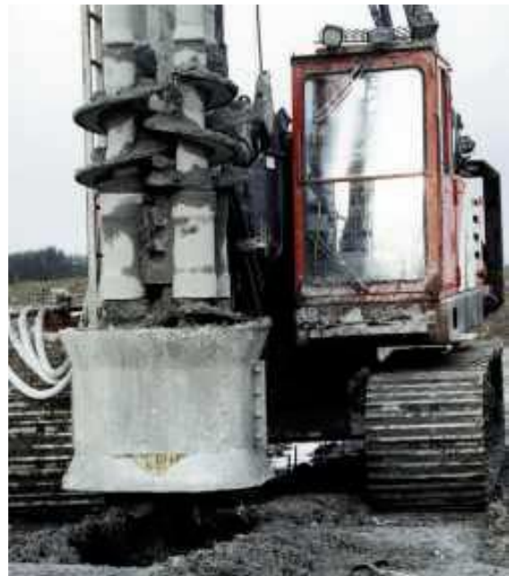
Slika 3-10. Primjeri različitih izvedbi strojeva sa radnim alatom za miješanje ( auger ) (Al-Tabbaa i Perera, 2006)
