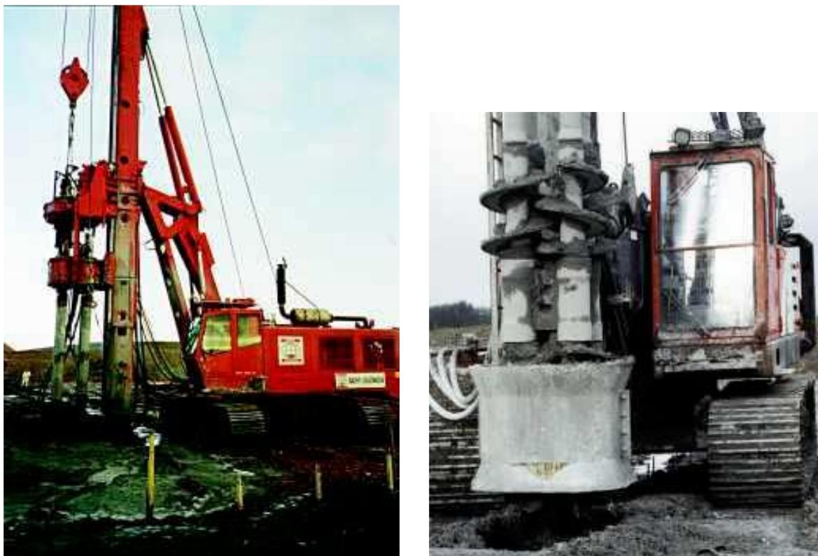
Slika 3-10. Primjeri različitih izvedbi strojeva sa radnim alatom za miješanje (auger) (Al-Tabbaa i Perera, 2006)
