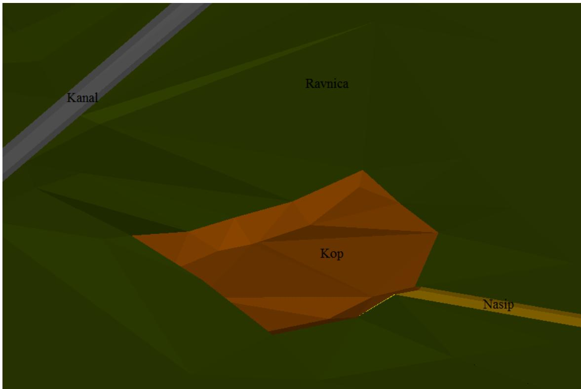
**Slika 5-1. 3D model stanja površinskog kopa nakon završene eksploracije**
