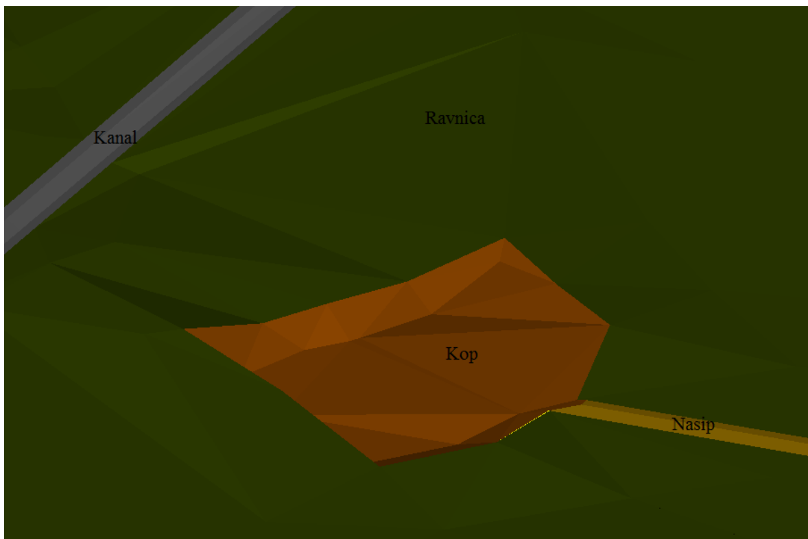
Slika 5-1. 3D model stanja površinskog kopa nakon završene eksploatacije
