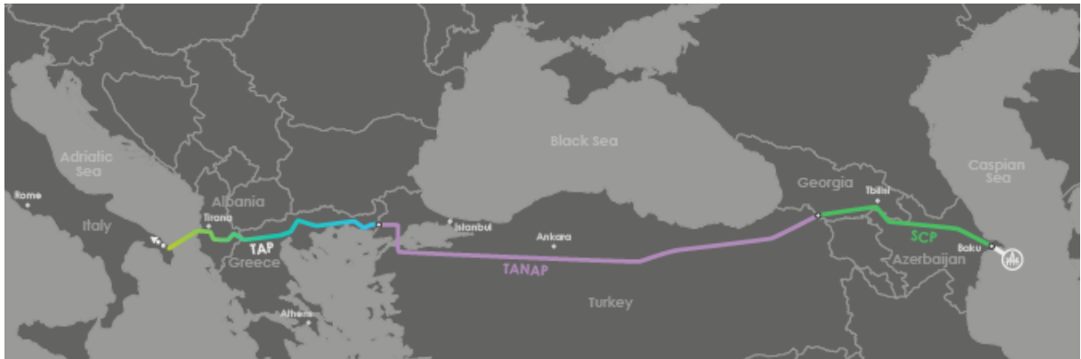
Slika 4-18. Dobavni pravac Južni Koridor koji se sastoji od cijele grupe međusobno integriranih infrastrukturnih projekata – SCP+TANAP+TAP (Trans Adriatic Pipeline AG, 2015a)
