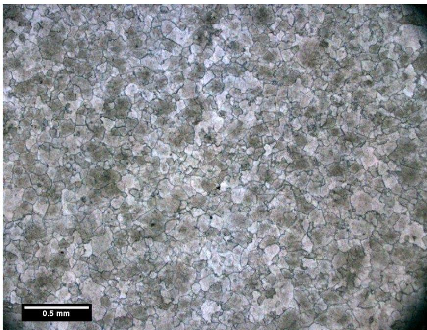
**Slika 4.11.** *Mikrofotografija uzorka M6 - struktura kasnodijagenetskog svijetlosivog dolomita*
