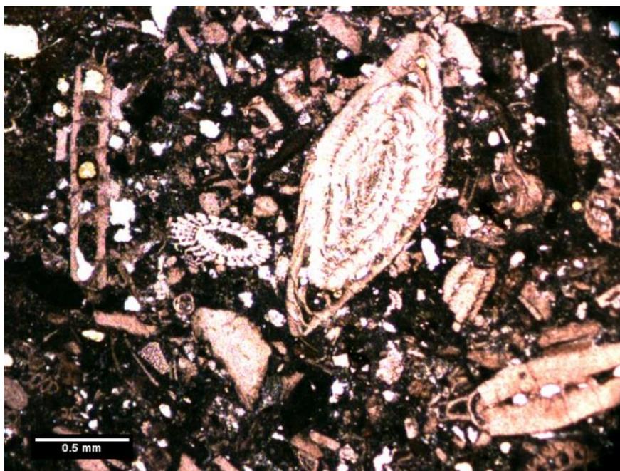
**Slika 4-23.** *Mikrofotografija uzorka M21 - litotamnijski vapnenac*
