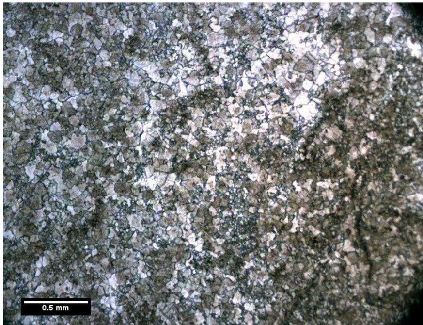
**Slika 4-10.** Mikrofotografija uzorka M5 - struktura kasnodijagenetskog tamnosivog dolomita
