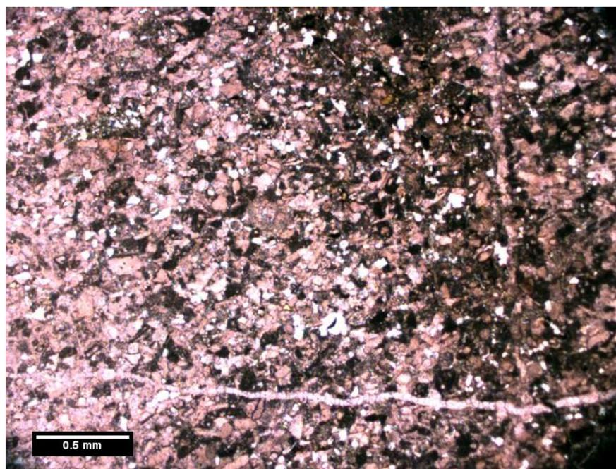
**Slika 4-17.** *Mikrofotografija uzorka M26 - karbonatni klastit (kalkarenit)*
