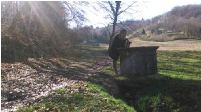
Slika 6.4. Mjerenje razine vode u zdencu 1 pomoću koluta
