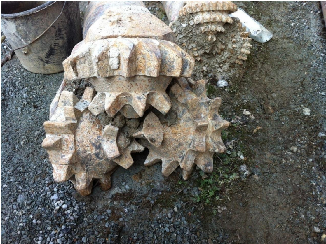
Slika 5-2. Žrvanjsko dlijeto korišteno u prvom dijelu bušenja.
