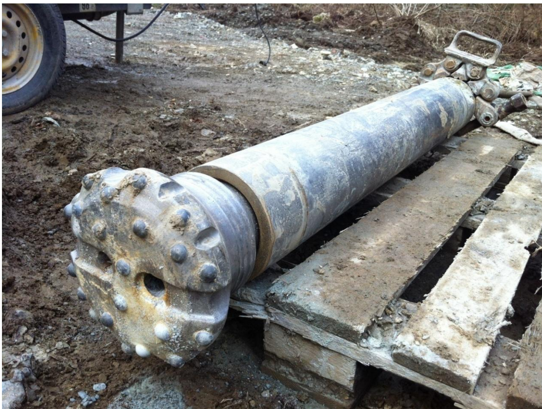
Slika 5-4. Čekić korišten u drugom dijelu bušenja.
