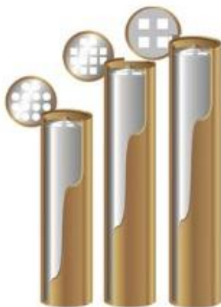
Slika 4-7 Vrste posuda za konačno odlaganje (Izvor: http://www.posiva.fi/en/final_disposal/basics_of_the_final_disposal/the_final_disposal_canister#.VdRi1Pntmko )
