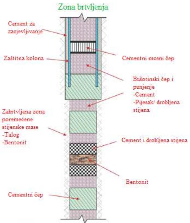
Slika 6-4. Osnovni dijelovi brtvenog sloja bušotine (Arnold et al, 2011).
