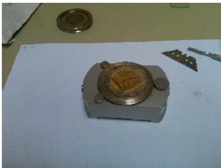
Slika 5. Priprema uzorka za rendgensku difrakciju na prahu
