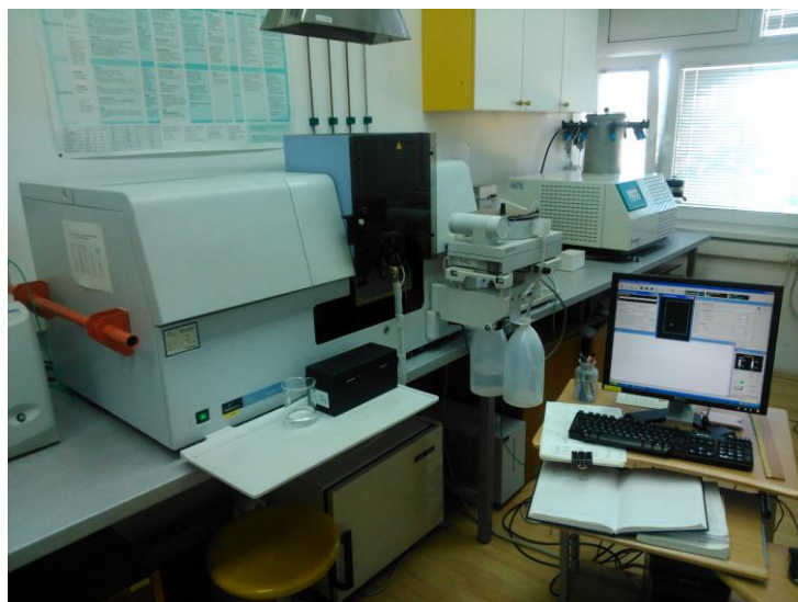
Slika 6. Atomski apsorpcijski spektrometar AAS 700
