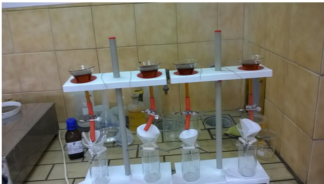
Slika 3 - 6 Aparatura za separaciju mineralnih frakcija teškim tekućinama
