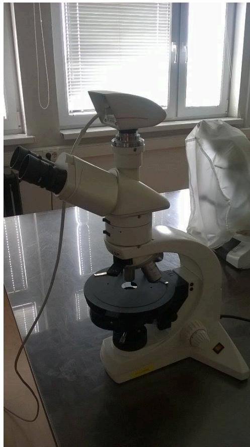
*Slika 3.7 Polarizacijski mikroskop Leica DM LSP*
