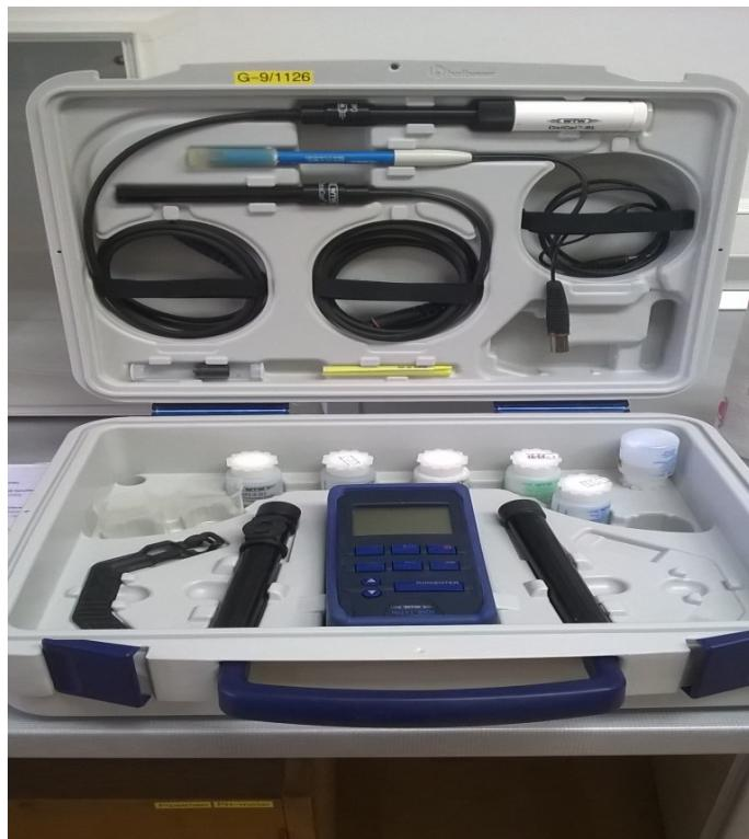
**Slika 3.2 Multi 3400i multimeter**
