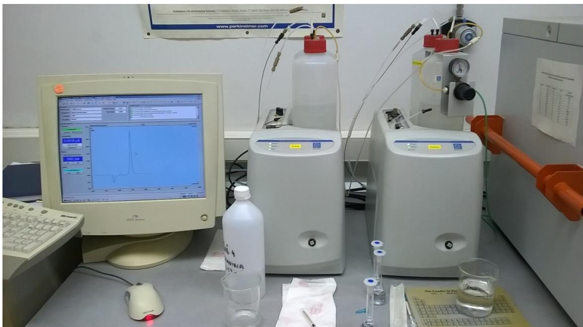
**Slika 3.4 Ionski kromatograf (*ICS-1000 Ion Chromatography System, Dionex*)**
