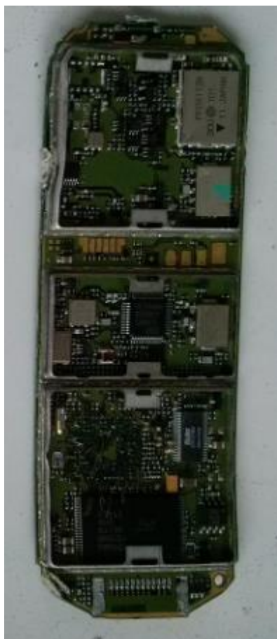
Slika 3-7. Primjer tiskane ploče mobilnog telefona
