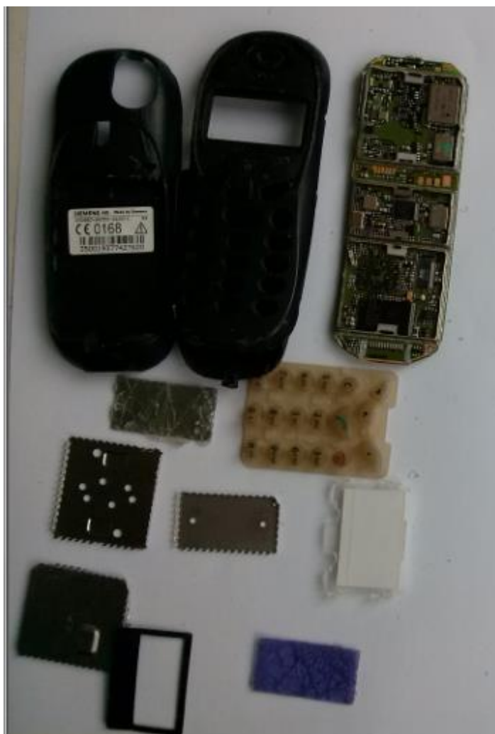
Slika 5-1. Ručno rastavljeni mobilni telefon
