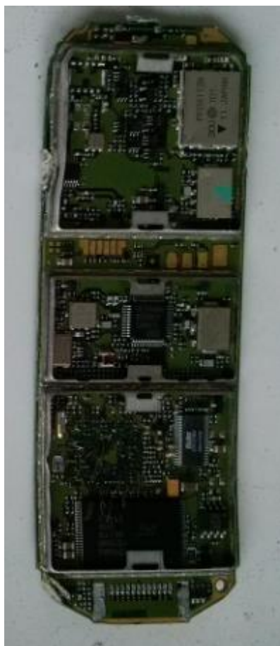
Slika 3-7. Primjer tiskane ploče mobilnog telefona
