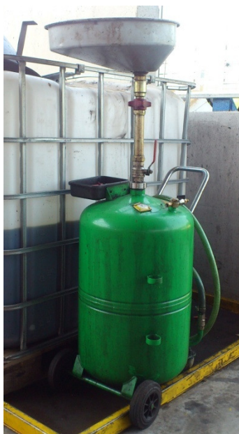
Slika 6.6. Posuda za ispuštanje ulja sa pantogramom za izvlačenje i sabiranje
