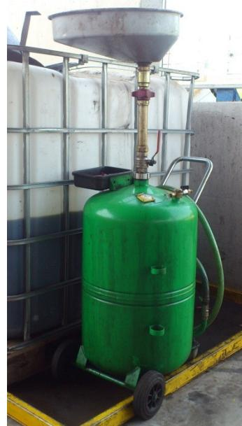
Slika 6.6. Posuda za ispuštanje ulja sa pantogramom za izvlačenje i sabiranje
