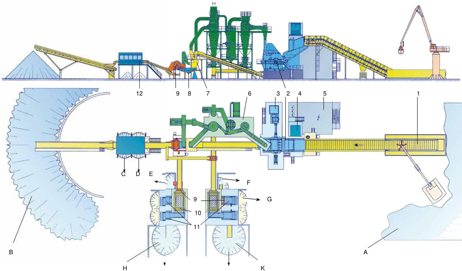
Slika 6.11. Shematski prikaz „Zerdirator“ postrojenja za recikliranje otpadnih automobila (C.I.O.S grupa, 2009)
