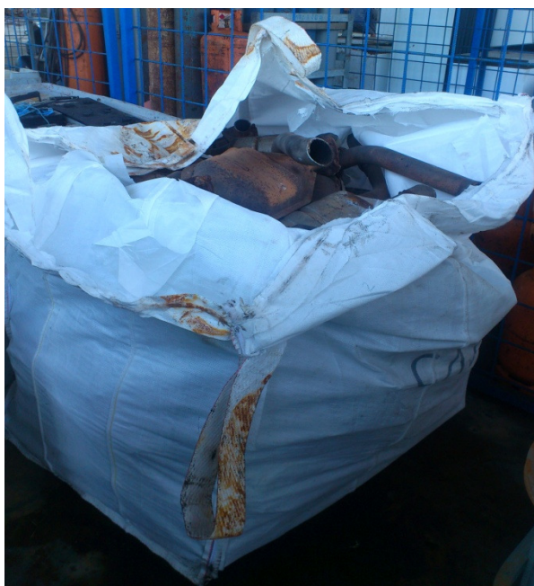
Slika 6.4. Katalizatori skinuti sa vozila
