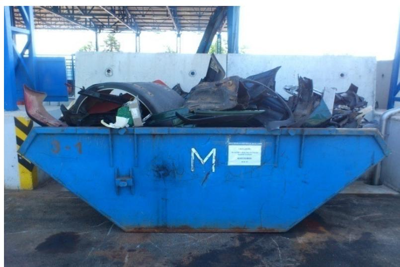
Slika 6.5. Plastični dijelovi skinuti sa vozila
