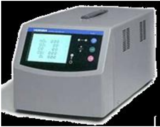
Slika 4-20. Analizator dimnih plinova PG-250A (EKONERG d.o.o., 2015)
