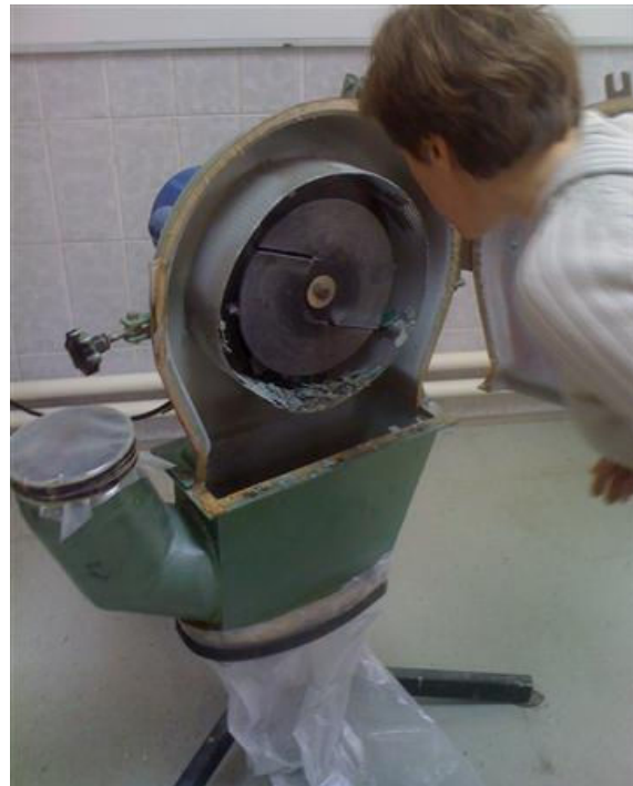
Slika 23. Mlin čekićar za II. stupanj usitnjavanja uzoraka, Laboratorija za oplemenjivanje i ispitivanje mineralnih sirovina
