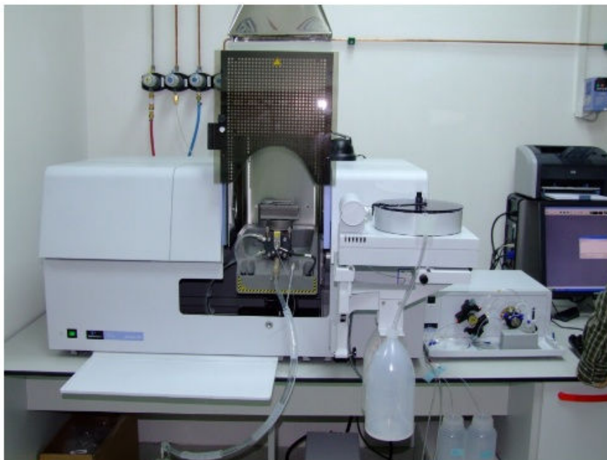
Slika 28. Atomski apsorpcijski spektrometar Laboratorija za geokemiju okoliša
