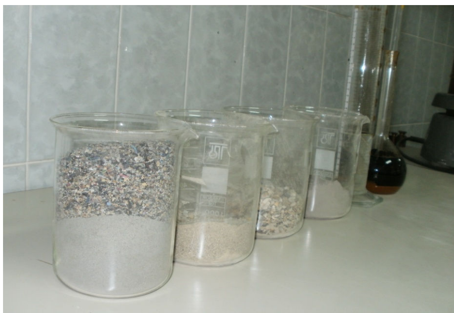
Slika 29. Sastojci betona pripremljeni za pripremu betonskih kocki
