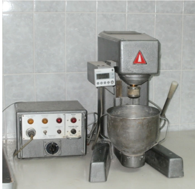
Slika 30. Mješalica za laboratorijsku pripremu betona
