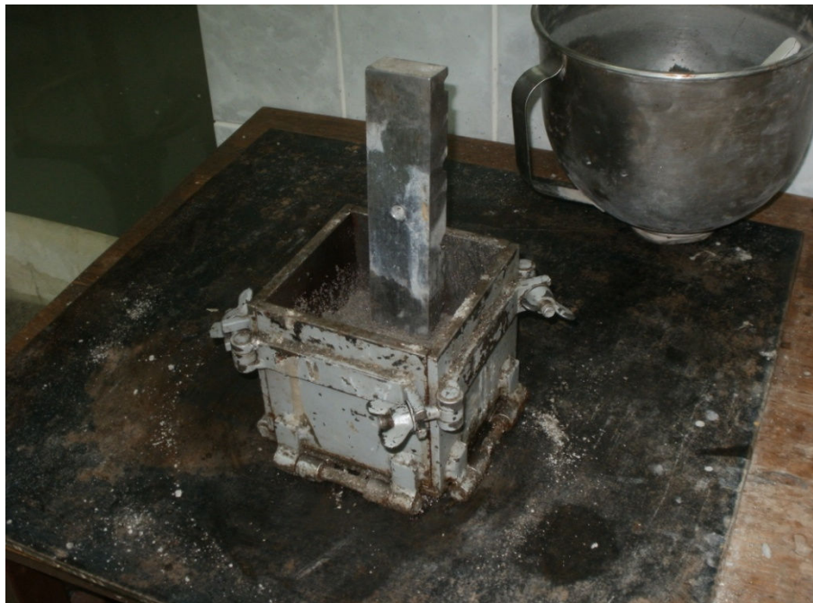
Slika 31. Ugradnja betona u kalup
