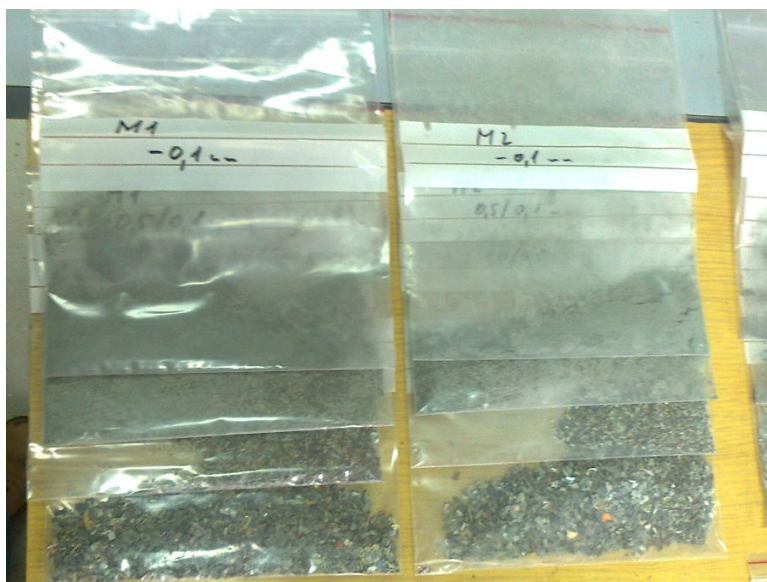
Slika 24. Uzorci mobitela (M1 i M2) usitnjeni i klasirani na 4 klase – pripremljeni za otapanje u zlatotopci
