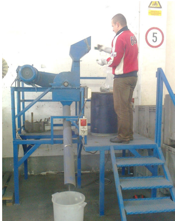
Slika 22. Drobilica za I. stupanj sitnenja uzoraka, Spectra Media d.o.o., pogon Donja Bistra
