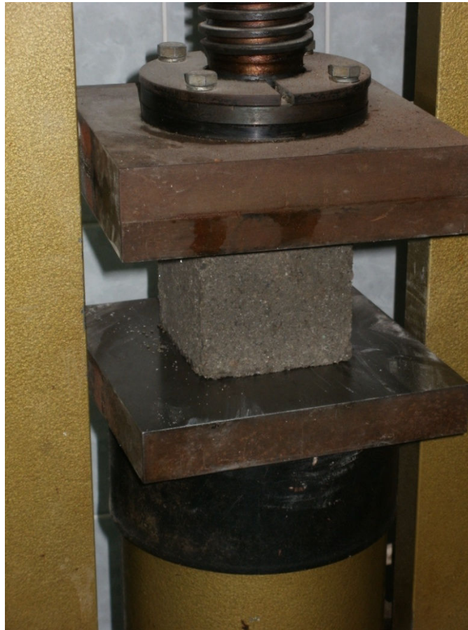
Slika 34. Ispitivanje tlačne čvrstoće u laboratorijskoj preši
