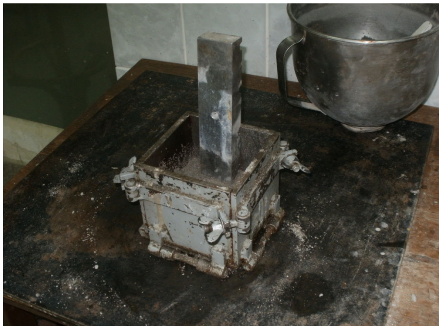
Slika 31. Ugradnja betona u kalup
