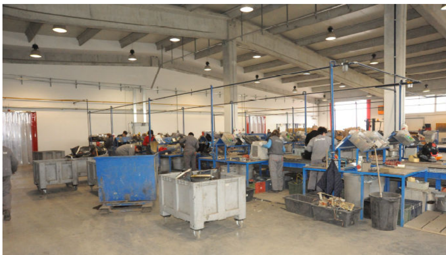
Slika 6. Prva faza obrade EE otpada (rastavljanje) u pogonu tvrtke Spectra-Media d.o.o. u Virovitici
