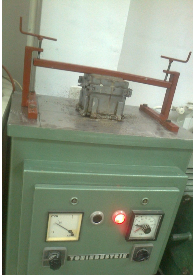
Slika 32. Vibrostol za strojno sabijanje uzoraka, Tonindustrie
