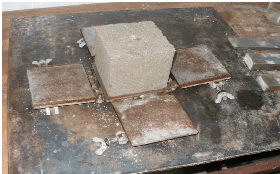
Slika 33. Vađenje kocke iz kalupa
