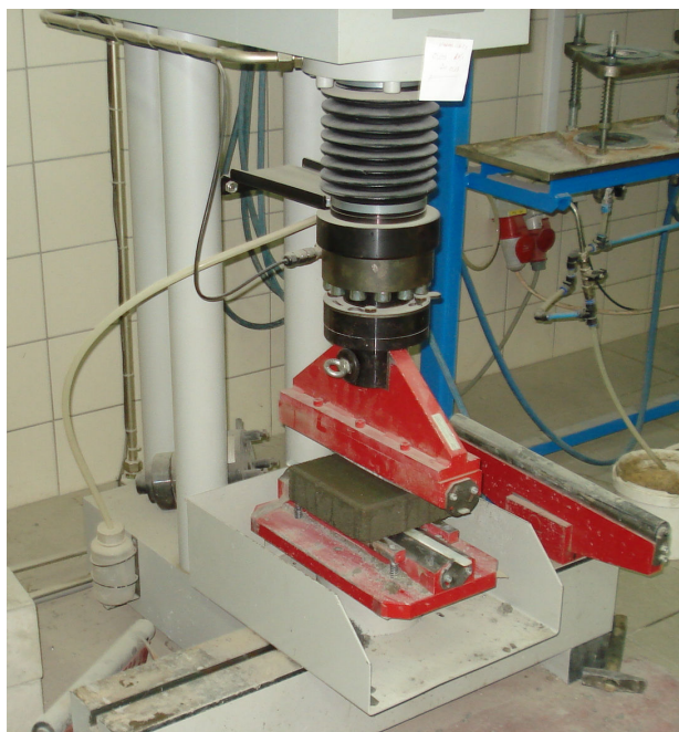
Slika 38. Ispitivanje vlačne čvrstoće cijepanjem, Zagorje Tehnobeton, d.d., pogon Varaždin
