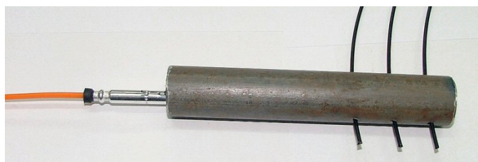
Slika 6-15. Fotografija mjernog postava u čeličnoj cijevi unutarnjeg promjera \varnothing 20 mm.
