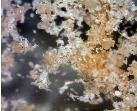
Slika 6-5. Struktura smjese Permonexa V19 i EPS-a (– 0,1 mm) u omjeru 50:50 (uvećanje 200×, mikroskop Dino-Lite Pro).
