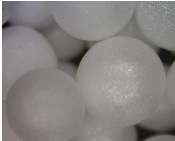
Slika 6-2. Zrnca granuliranog EPS-a (1,5 mm – 3,5 mm, uvećanje 50×, mikroskop Dino-Lite Pro).
