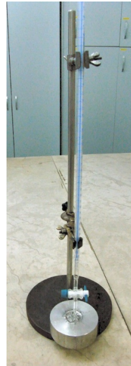
Slika 6-24. Određivanje volumena udubljenja na Al pločici.
