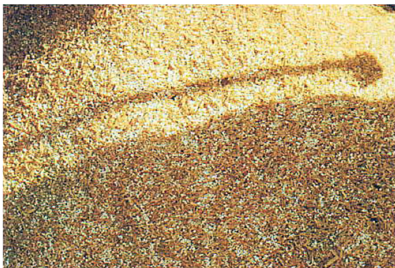
Slika 4-23. BlastLite – mješavina ANFO-eksploziva i ljusaka pšenice (Beach et al, 2004).
