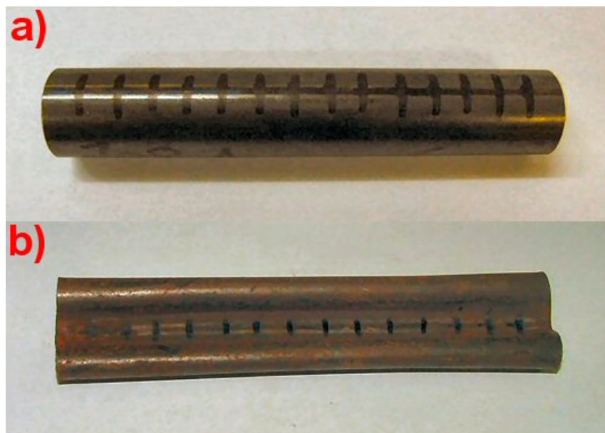
Slika 6-29. Određivanje deformacije ispitne cijevi.
