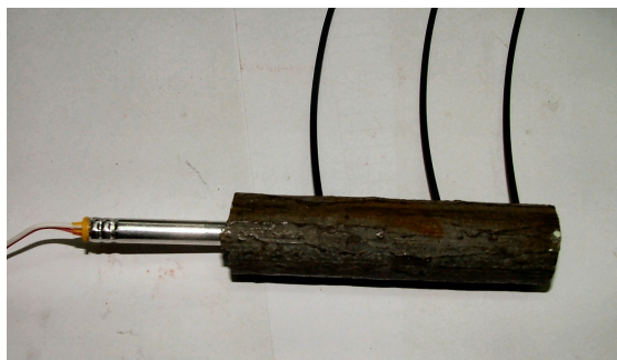
Slika 6-16. Fotografija mjernog postava u čeličnoj cijevi unutarnjeg promjera \varnothing 16 mm.
