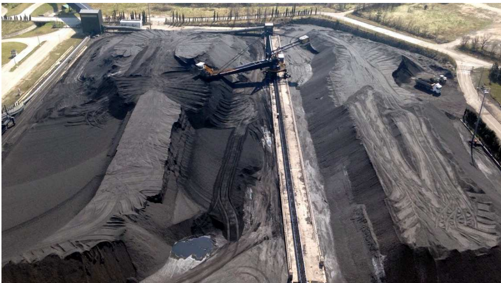
Slika 2-5. Otvoreni deponij ugljena TE Plomin
