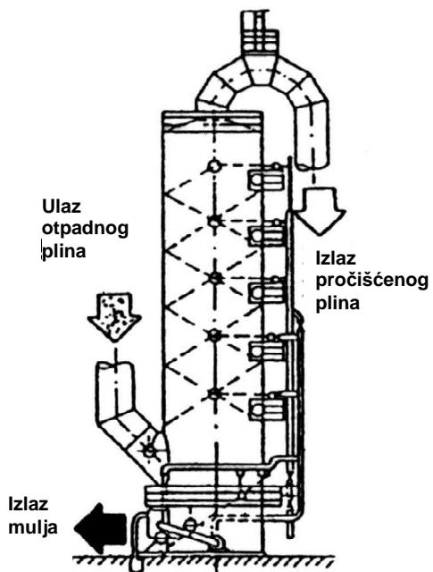
Slika 4-11. Postrojenje za odsumporavanje dimnih plinova (DeSOx) TEP 2 (Vukelić, 2013.)
