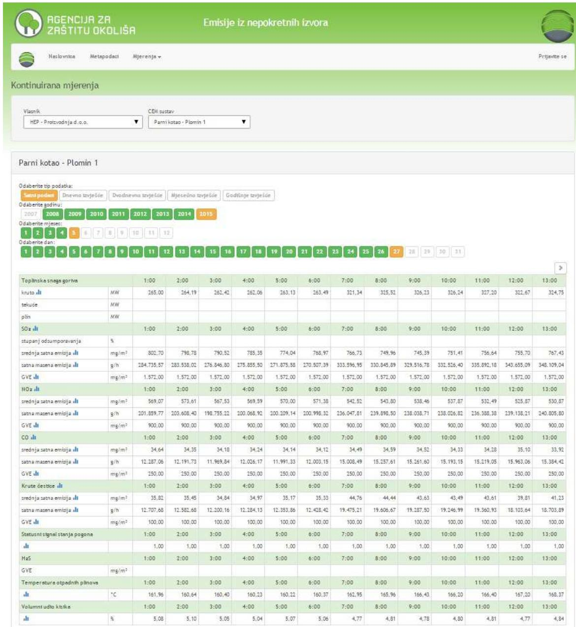
Slika 4-15. Satni rezultati kontinuiranih mjerena za TEP 1 (AZO, 2015.)
