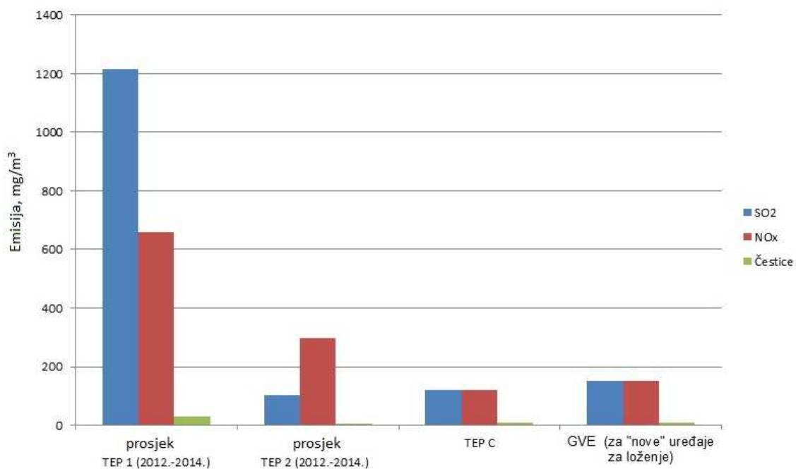
Slika 6-2. Usporedba emisija NO<sub>x</sub>, SO<sub>2</sub> i krutih čestica iz TEP 1, TEP 2 i TEP C (EKONERG d.o.o., 2013.a-b, 2014.a-b, 2015.a-b; HEP Proizvodnja d.o.o., 2011.)
