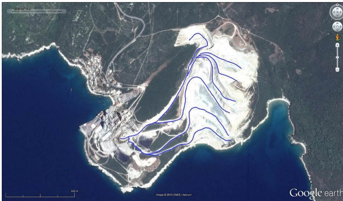
Slika 2-3. Prikaz transportnih trasa u površinskom kopu Koromačno
