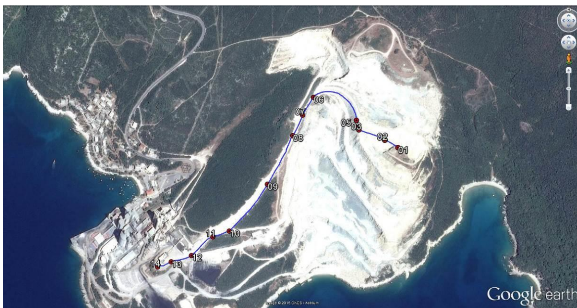
Slika 2-14. Prikaz transportne trase od šeste etaže do drobilice
