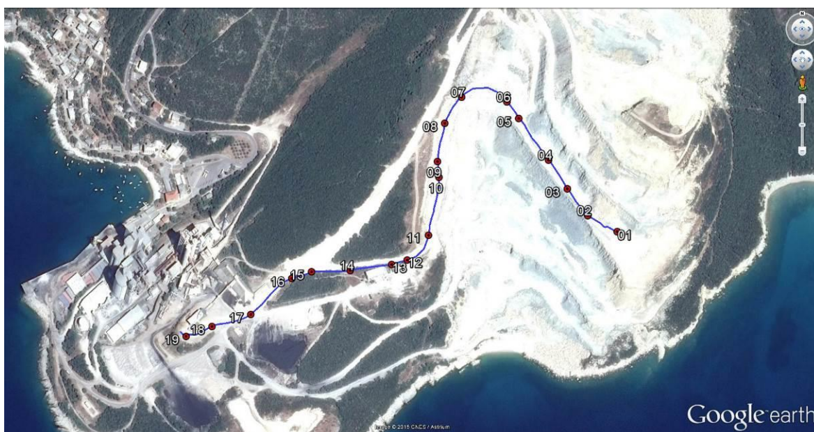
Slika 2-8. Prikaz transportne trase od četvrte etaže do drobilice
