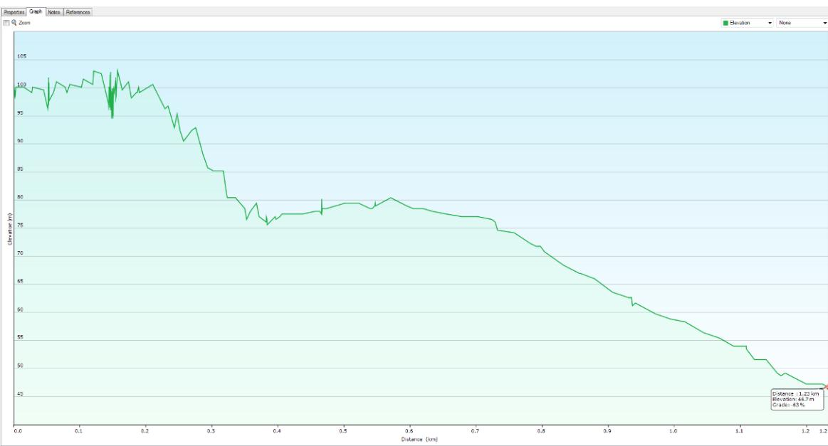
**Slika 2-15.** Uzdužni presjek trase od šeste etaže do drobilice (na apscisi prikazan pomak duž trase u kilometrima, na ordinati nadmorska visina u metrima)
