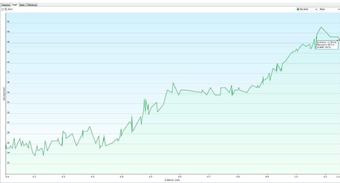
**Slika 2-7.** Uzdužni presjek trase od treće etaže do drobilice (na apscisi prikazan pomak duž trase u kilometrima, na ordinati nadmorska visina u metrima)
