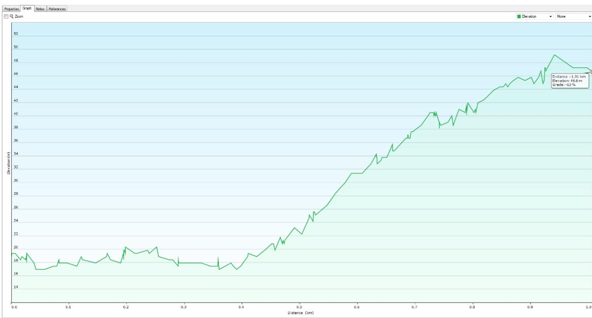
**Slika 2-5.** Uzdužni presjek trase od druge etaže do drobilice (na apscisi prikazan pomak duž trase u kilometrima, na ordinati nadmorska visina u metrima)
