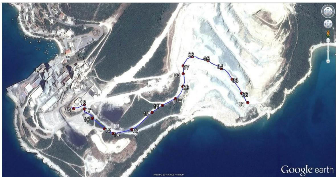
Slika 2-6. Prikaz transportne trase od treće etaže do drobilice
