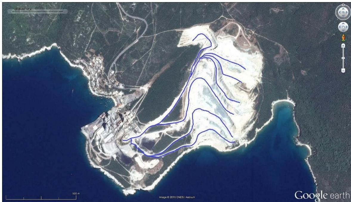
**Slika 2-3.** Prikaz transportnih trasa u površinskom kopu Koromačno
