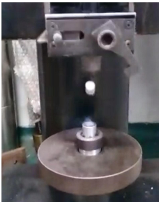
Slika 5-11. Fotografija reakcije prilikom određivanja osjetljivosti na udar.
