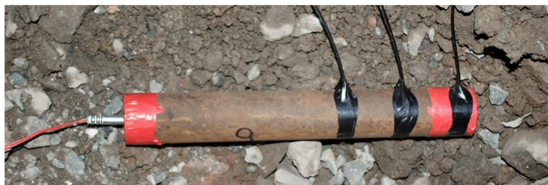
Slika 5-8. Fotografija mjerenja – iniciranje detonatorom.
