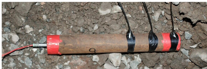
Slika 5-8. Fotografija mjerenja – iniciranje detonatorom.
