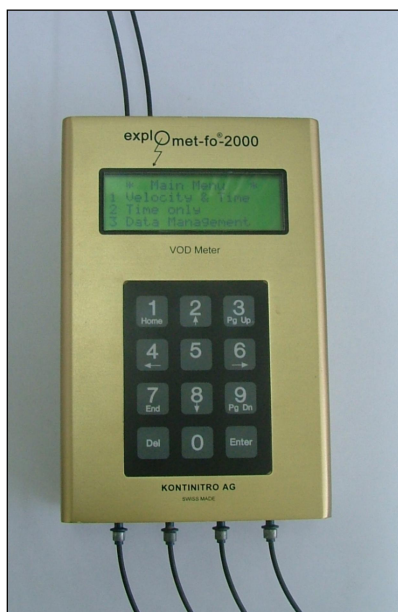
Slika 5-4. Elektronički sat Explomet – Fo 2000.
