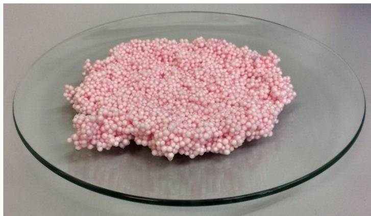
Slika 5-3. Emulzijski eksploziv smanjne gustoće.
