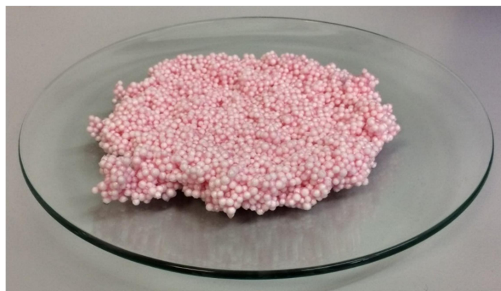
Slika 5-3. Emulzijski eksploziv smanjne gustoće.
