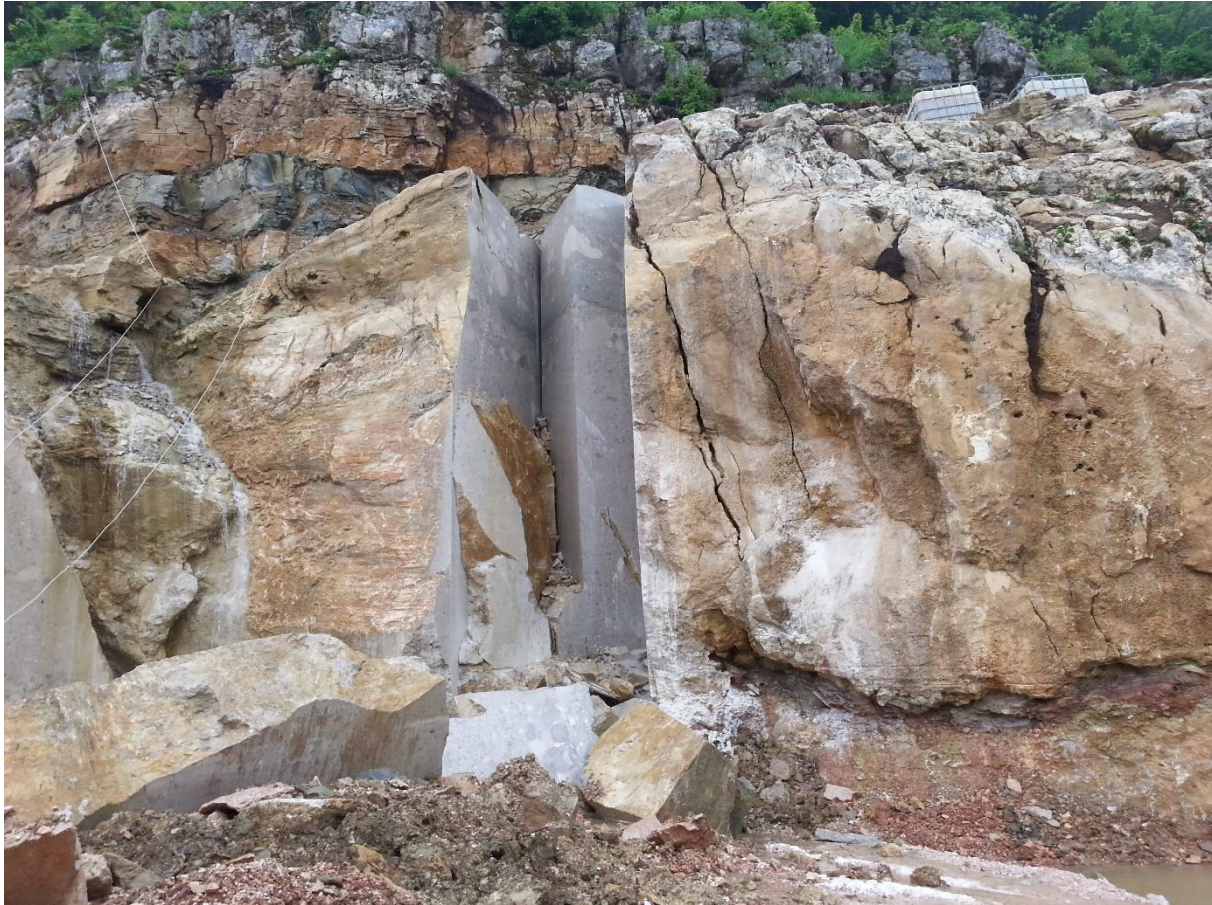
Slika 6.6. Istražni zasjek na čijoj su lijevoj strani vidljive decimetarske strije (IVANINIĆ & IVKIĆ, 2016).
