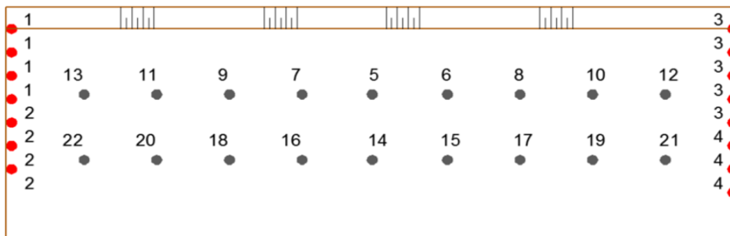
Slika 7-9. Redosljed otpucavanja minskih bušotina za I etažu
