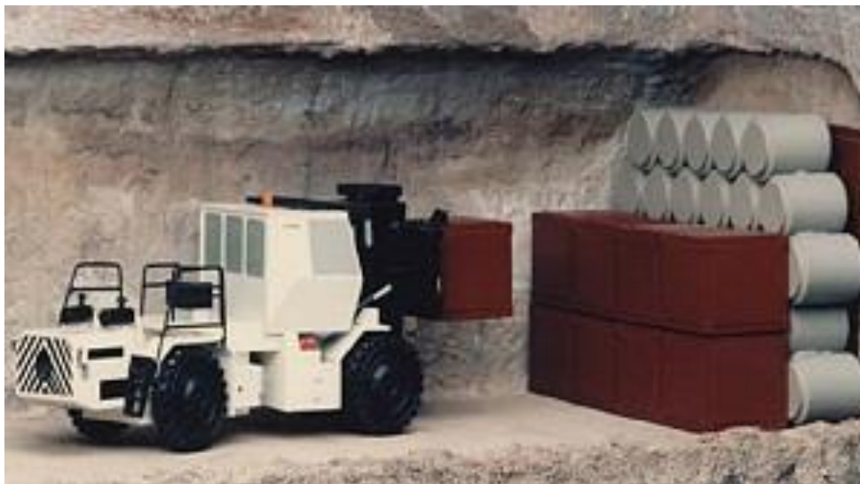
Slika 2-6. Shema smještanja otpada u odlagalištu Konrad, Njemačka (IAEA, 2015)
