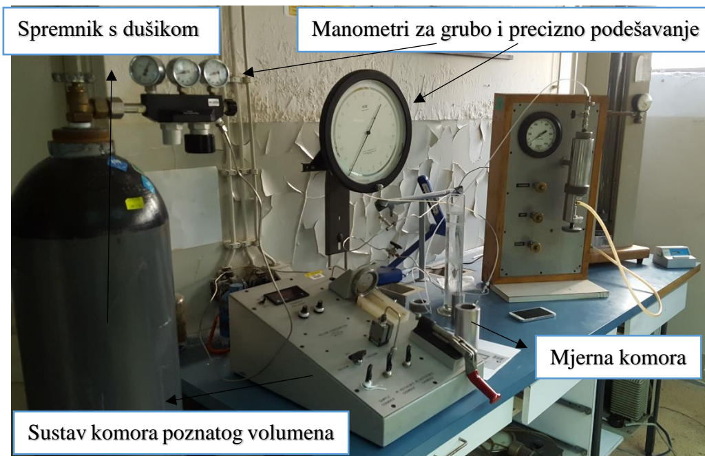
Slika 4-33. Oprema za mjerenje poroznosti.
