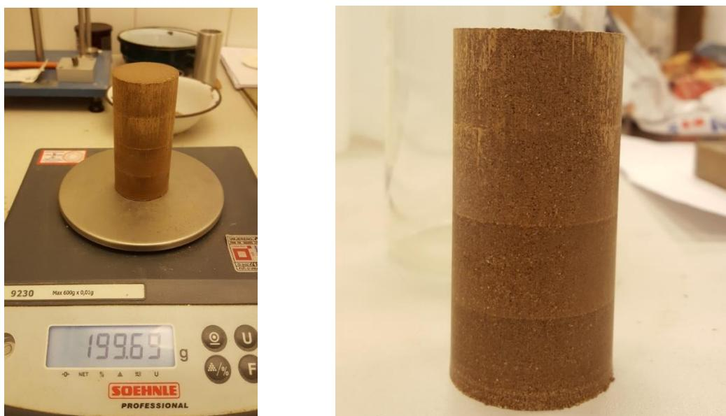
Slika 4-8. Masa uzorka br. 2 (lijevo), izgled uzorka (desno).
