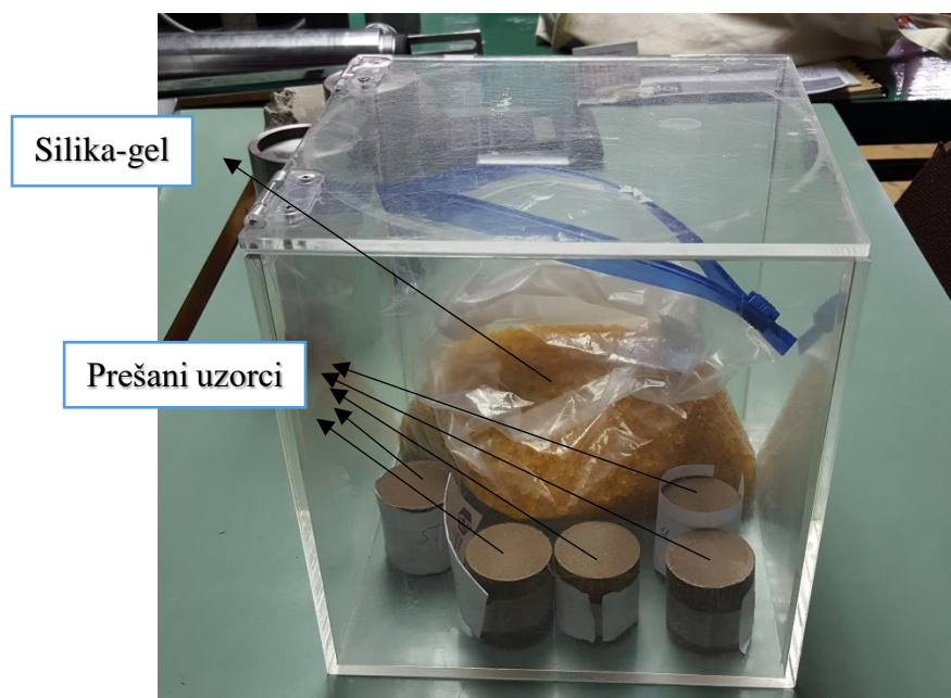
Slika 4-11. Prešani uzorci u posudi sa silika-gelom.
