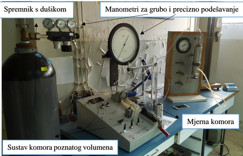
Slika 4-33. Oprema za mjerjenje poroznosti.
