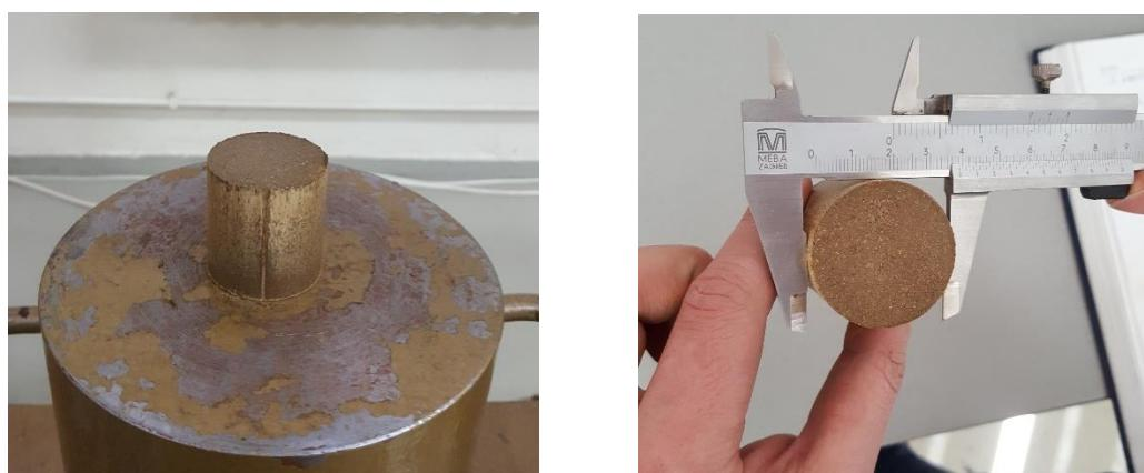
Slika 4-15. Dobiveni uzorak (lijevo), mjerjenje dimenzija promjera (desno).
