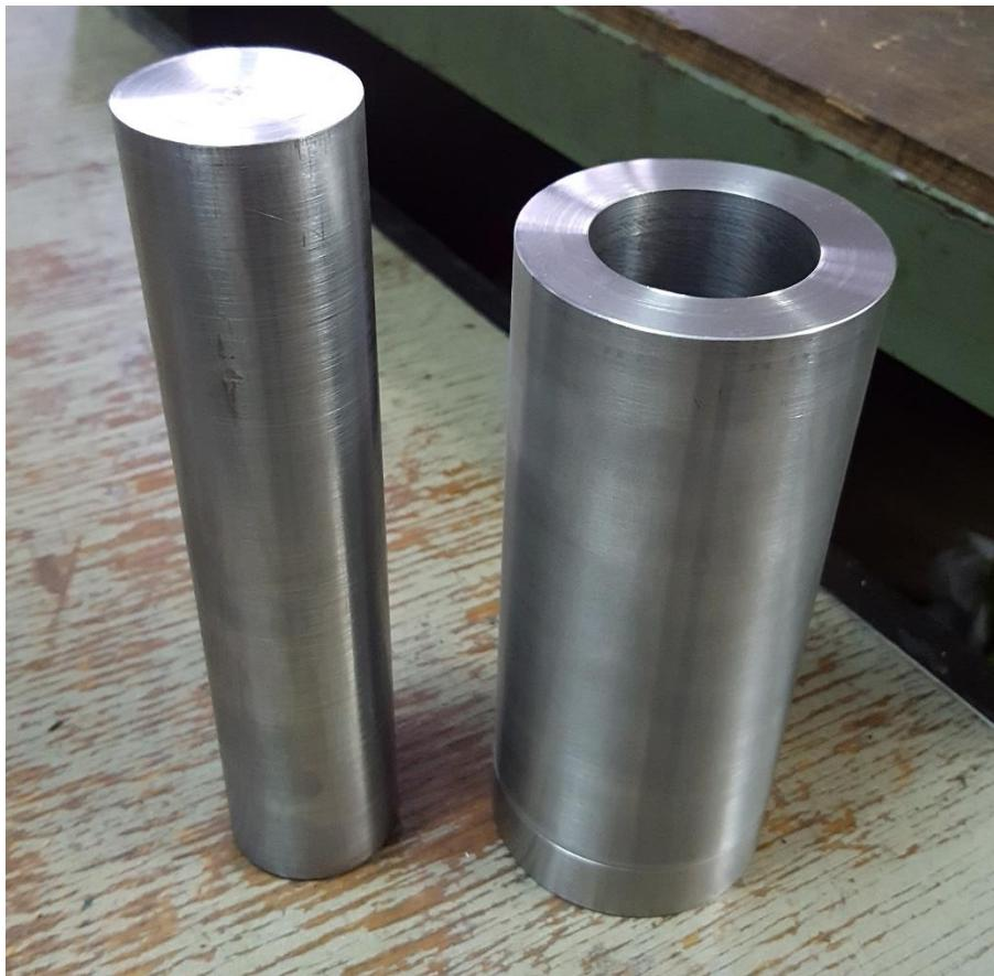
Slika 4-2. Kalup 1, cilindar (lijevo) i plašt (desno).
