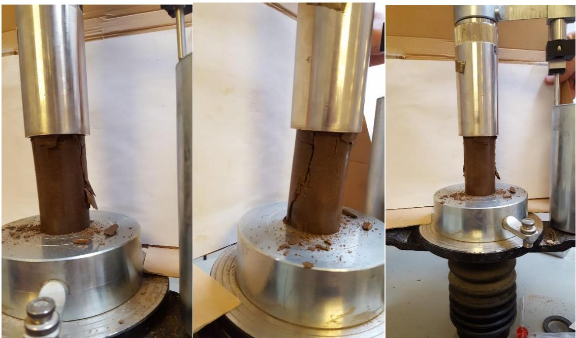
Slika 4-28. Slom uzorka, uzorak 4.
