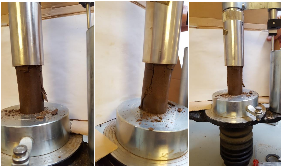
Slika 4-28. Slom uzorka, uzorak 4.
