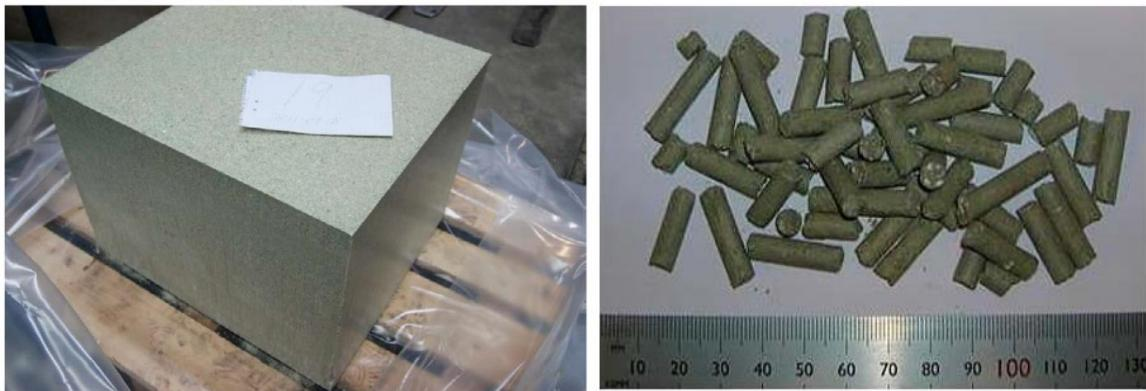
Slika 2-12. Prešana bentonitna glina oblika kocke (lijevo), bentonitni peleti (desno) (Morén, 2010).
