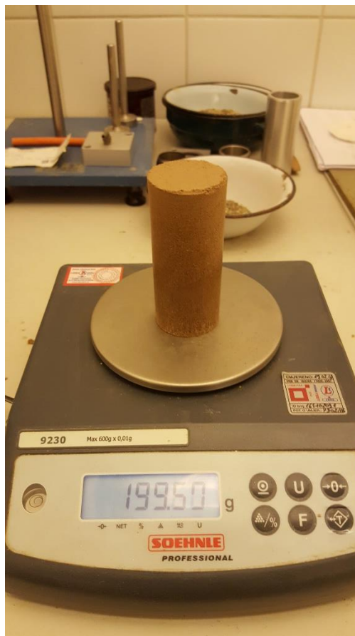
Slika 4-7. a) masa uzorka 1, b) masa uzorka 1 nakon prešanja, c) proces prešanja.
