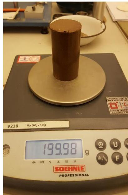
Slika 4-9. Izgled i izlazna masa uzorka 4.
