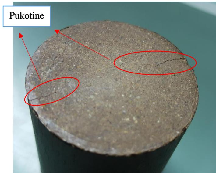
Slika 4-46. Pukotine uzrokovane maksimalnim ulaznim tlakom, uzorak 12.
