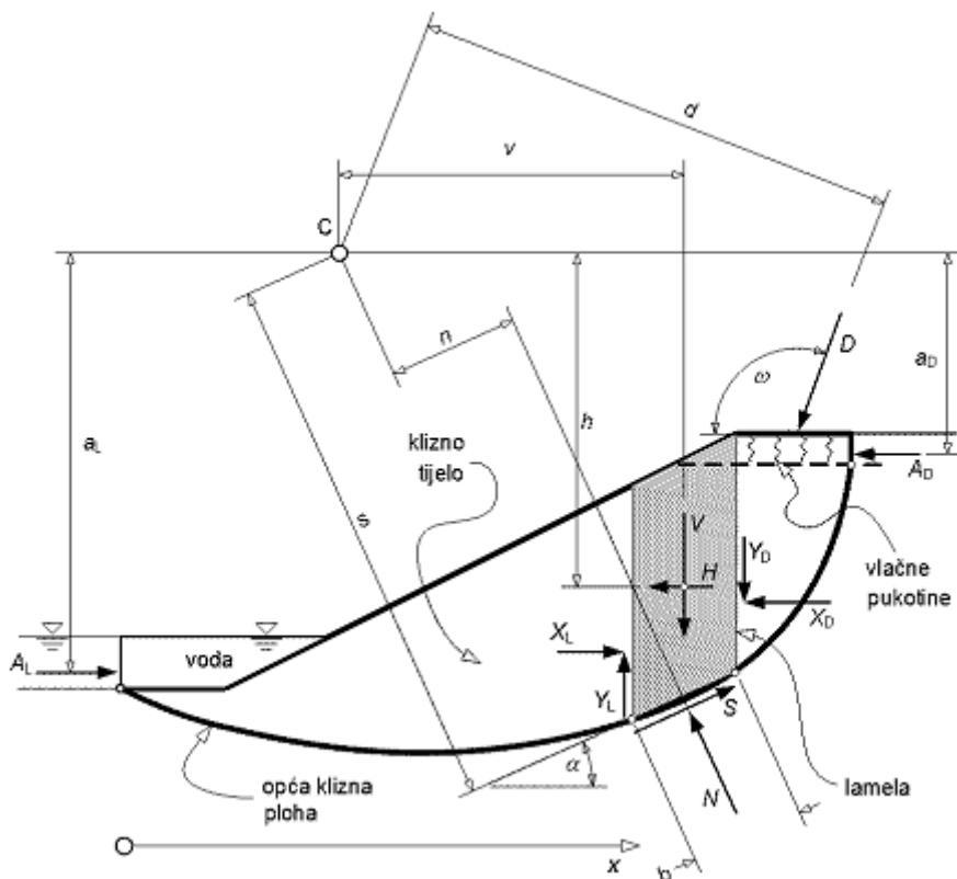
Slika 2-11. Sile na karakterističnoj lameli (Szavits-Nossan 2006)
