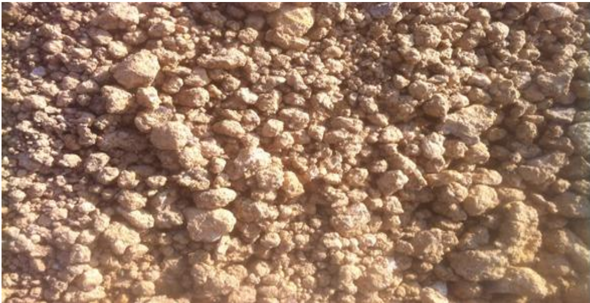
Slika 3-3. Prikaz glinovitog pijeska do prašinate gline
