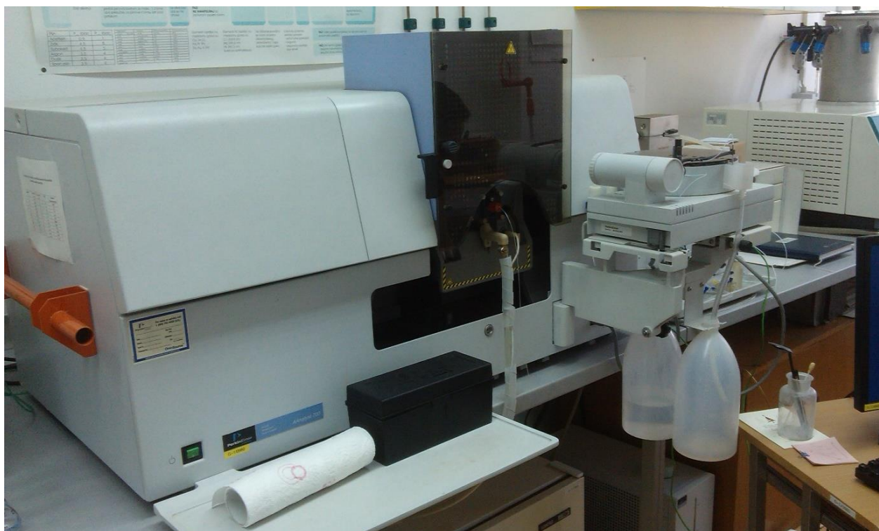
Slika 4-9. Atomski spektrometar PerkinsElmer AAnalyst 700 (foto: Dražen Tumara)
