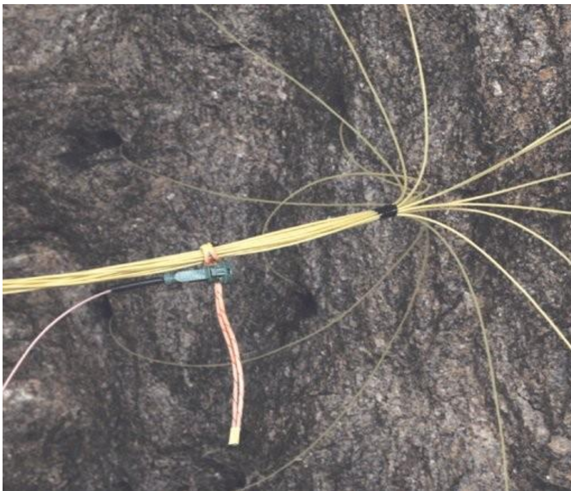
Slika 2-5. Prikaz „ bunch connectora “ (Gyslason 2000).
