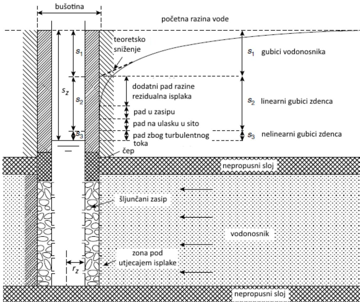
Slika 3.9. Komponente sniženja razine vode u zdencu (prema Delleur, 1999);  $s_z$  je sniženje u zdencu,  $r_z$  je radijus zdencu, a  $s_1$ ,  $s_2$  i  $s_3$  su komponente sniženja
