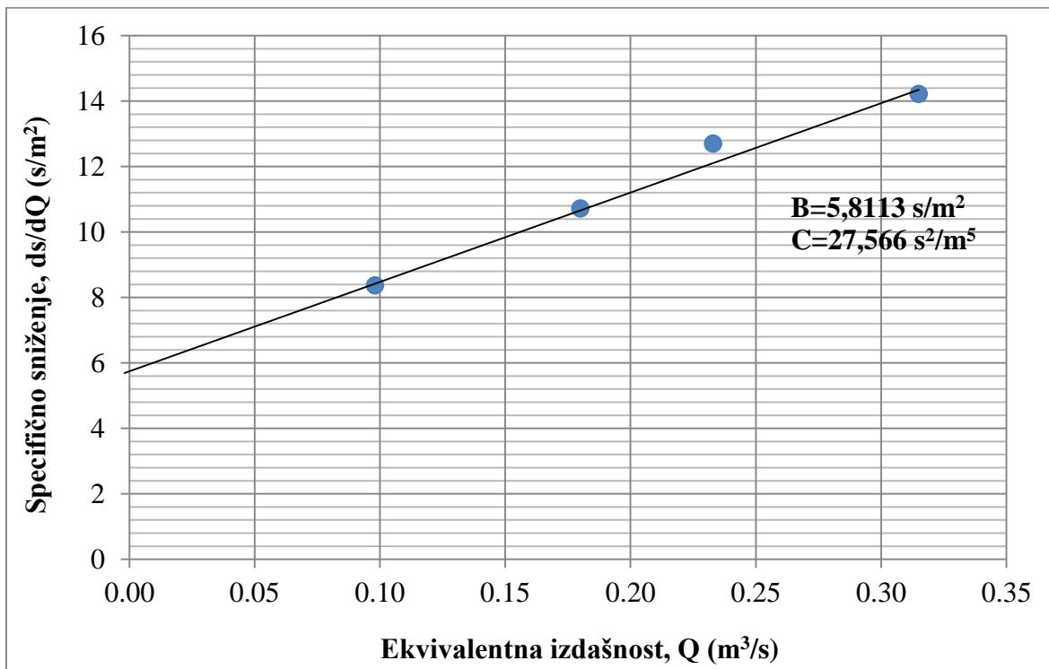
Slika 3.10. Grafička analiza ekvivalentnog specifičnog sniženja i ekvivalentne izdašnosti istražno – eksploracijskog zdenca ZČ-1 prema podacima iz tablice
