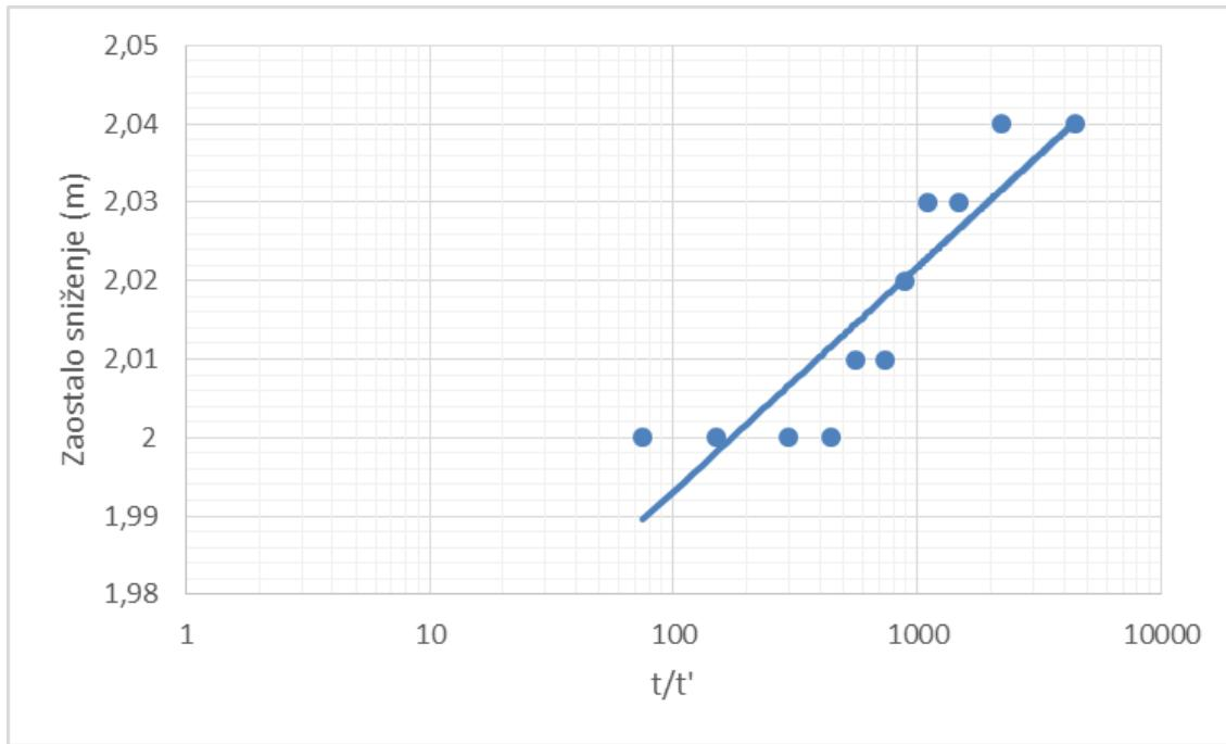
Slika 3.5. Dijagram zaostalog sniženja u piezometru D-1
