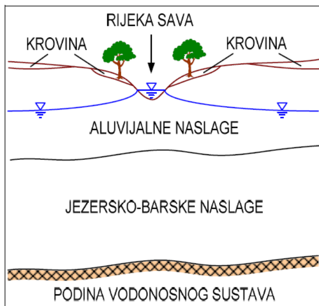
Slika 2.3. Shematski profil zagrebačkog vodonosnog sustava (preuzeto iz Posavec, 2006)
