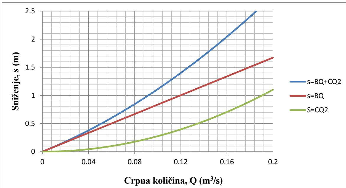
Slika 3.11. Dijagram  $s=f(Q)$  i pojedine vrste gubitaka za crpljenje u istražno eksploracijskom zdencu ZČ-1
