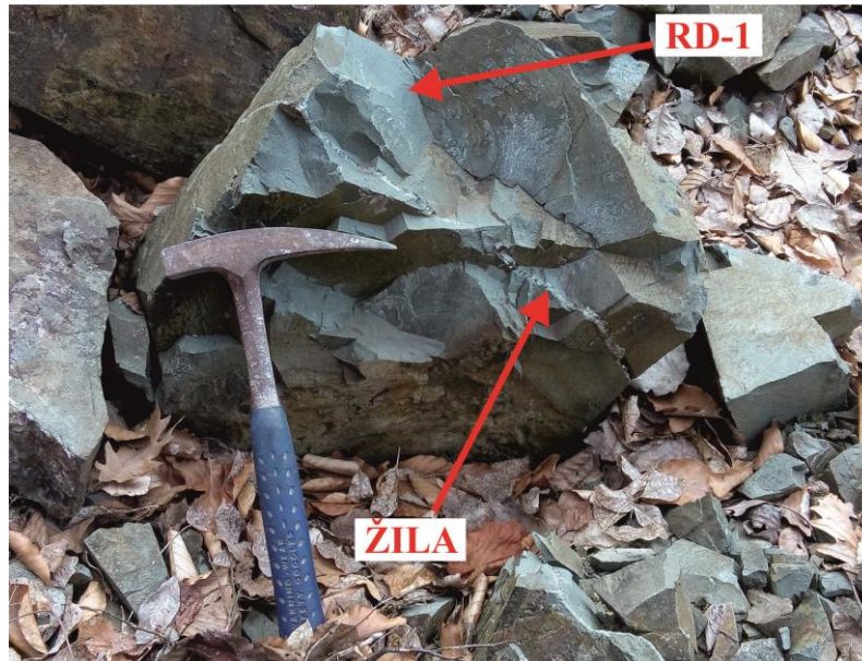
Slika 1-2. Odronjeni blok iz kojeg je uzet uzorak RD-1. Označena je žila ispunjena sekundarnim mineralima (lokalitet Radiša).
