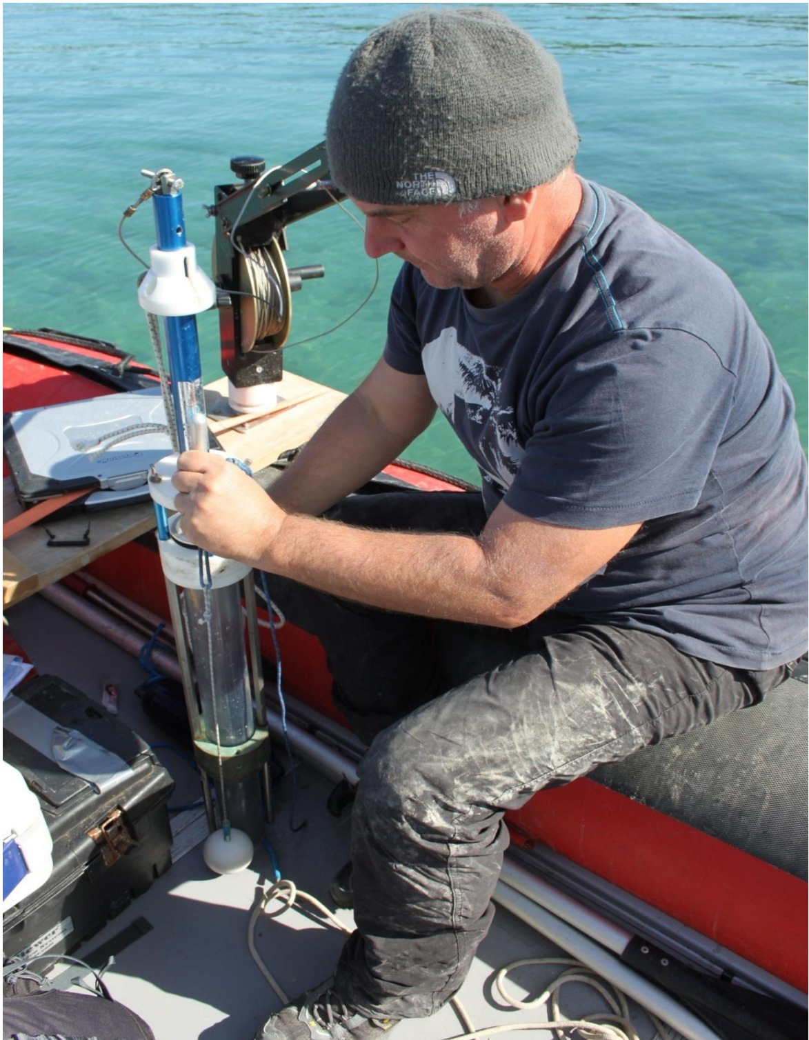
Slika 3.2. Uzorkovanje gravitacijskim korerom.
