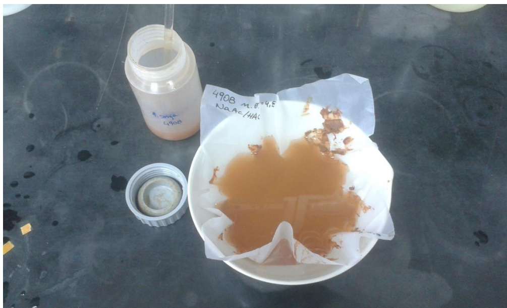
Slika 4-3. Uzorak na foliji prije stavljanja na parnu kupelj
