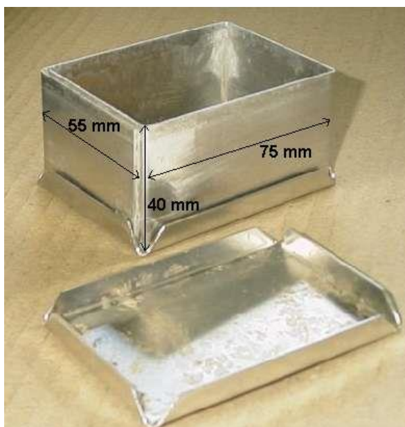
Slika 4-6. Primjer Kubienine kutije za uzorkovanje (izvor: http://www.thin.stir.ac.uk/consultancy/ )
