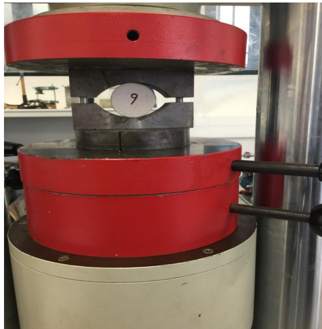
Slika 6-7 Indirektno ispitivanje vlačne čvrstoće Brazilskim testom
