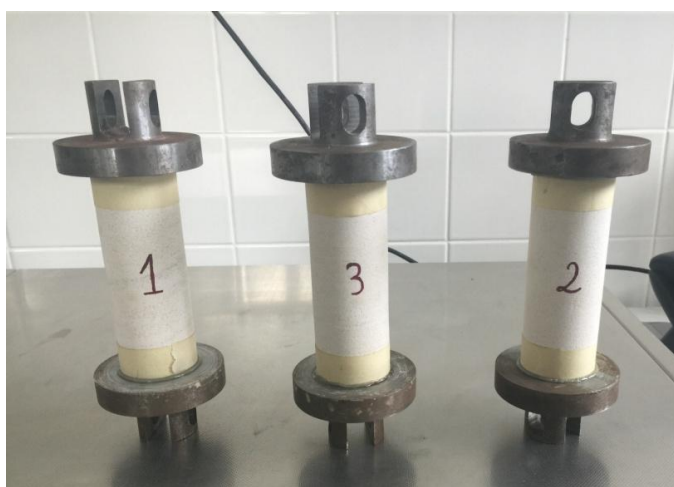
Slika 6-2 Uzorci cementirani na metalne kapice
