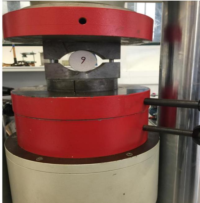
Slika 6-7 Indirektno ispitivanje vlačne čvrstoće Brazilskim testom
