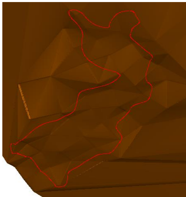
Slika 6-8. Prikaz „zalijepljene“ konture ležišta L-27 na kontaktnu plohu.
