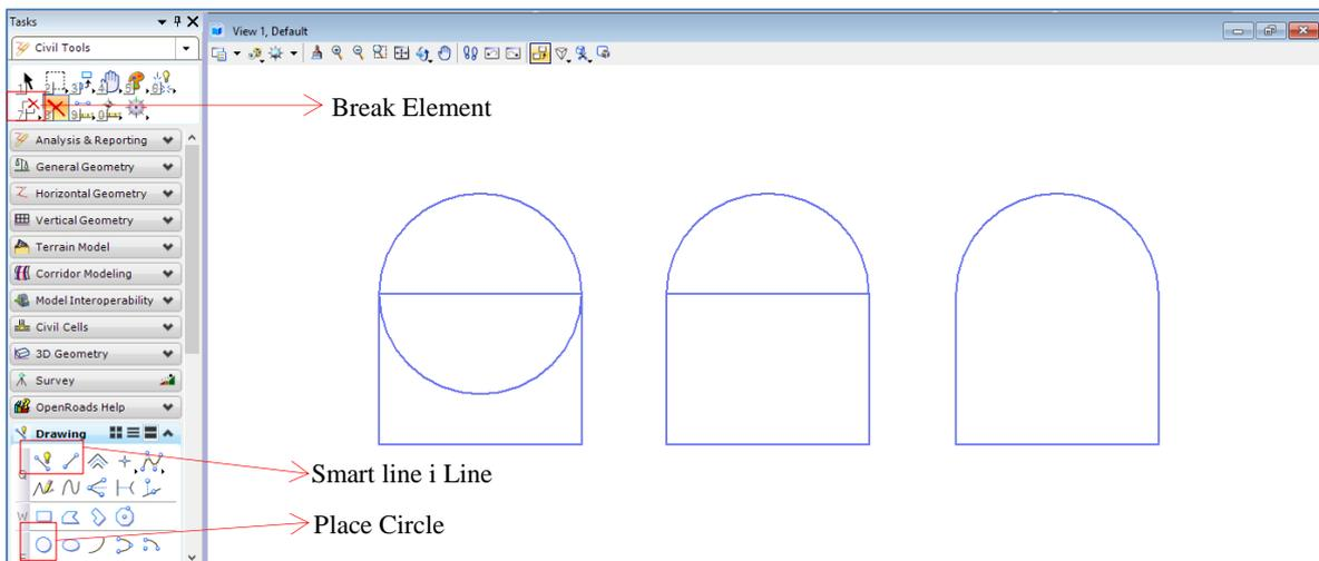
**Slika 7-1.** Prikaz kreiranja poprečnog profila podzemnih prostorija
