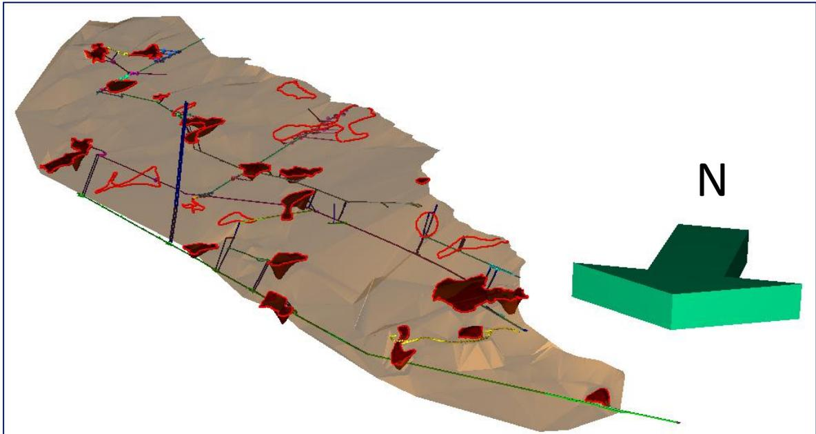
**Slika 4-2.** Prikaz rasporeda podzemnih prostorija (3d) u odnosu na istražena ležišta boksita
