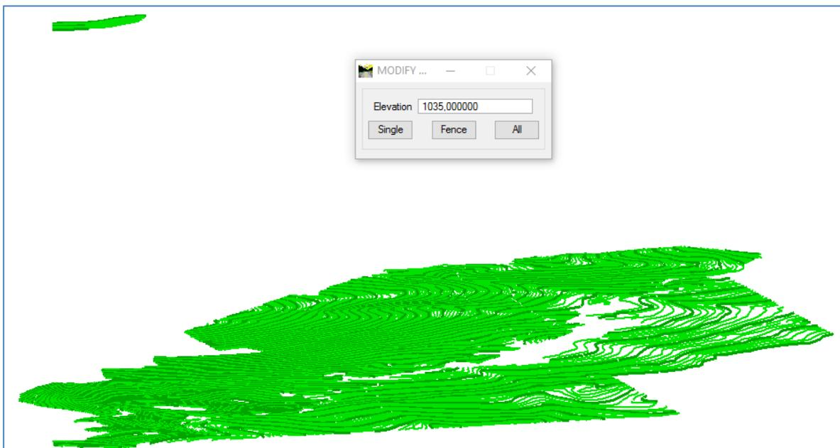
Slika 5-2. Prikaz „dizanja“ slojnica iz 2d u 3d okruženje
