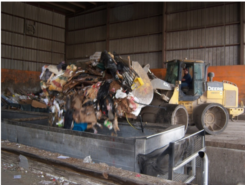
Slika 6-3. Zatvorena PS denivelirana u pola etaže s jednim pretovarnim mjestom s unosom otpada pomoću manipulativnog stroja (utovarivača) u prikolicu ili poluprikolicu (Hidroing, 2014)
