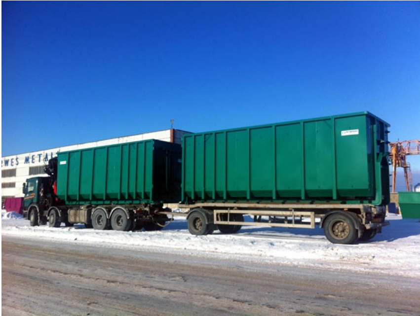
Slika 6-6. Prijevoz rolo ili pres-kontejnera kamionom s prikolicom (Hidroing, 2014)
