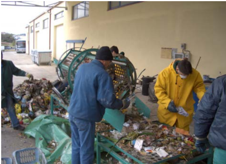
Slika 3-3. Ručno probiranje otpada na perforiranom stolu
