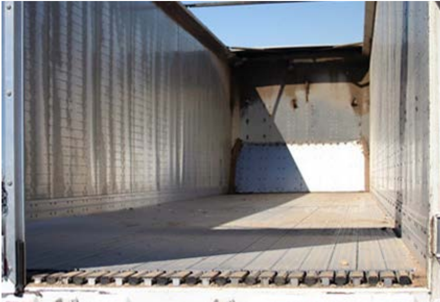
Slika 6-8. Prijevoz otpada kamionom s prikolicom (izvedba bez prešanja i istovara pomoću pokretnog poda) (IPZ, 2014)
