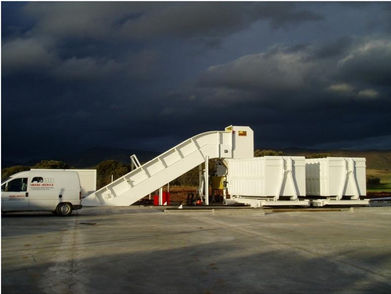
Slika 6-2. Nenatkrivena – "u pravilu natkrivena" automatska PS u jednoj etaži s jednim pretovarnim mjestom s unosom otpada transportnom trakom (elevatorom) u stacionarnu prešu i potiskom sprešanog otpada u rolo-kontejner(Hidroing, 2014)
