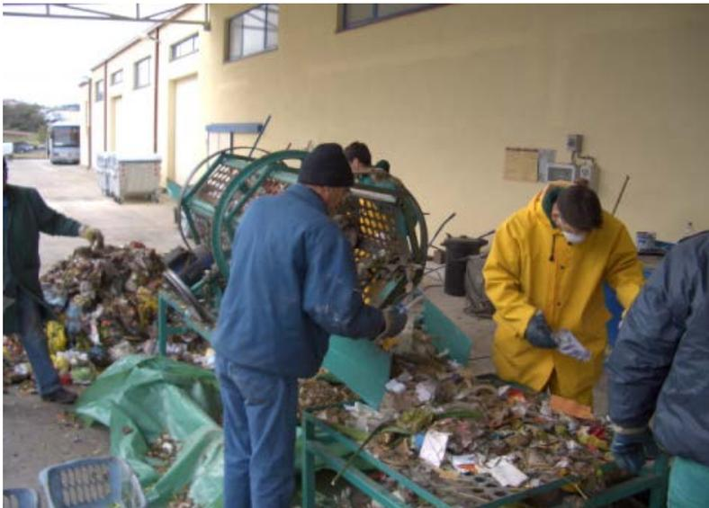
Slika 3-3. Ručno probiranje otpada na perforiranom stolu
