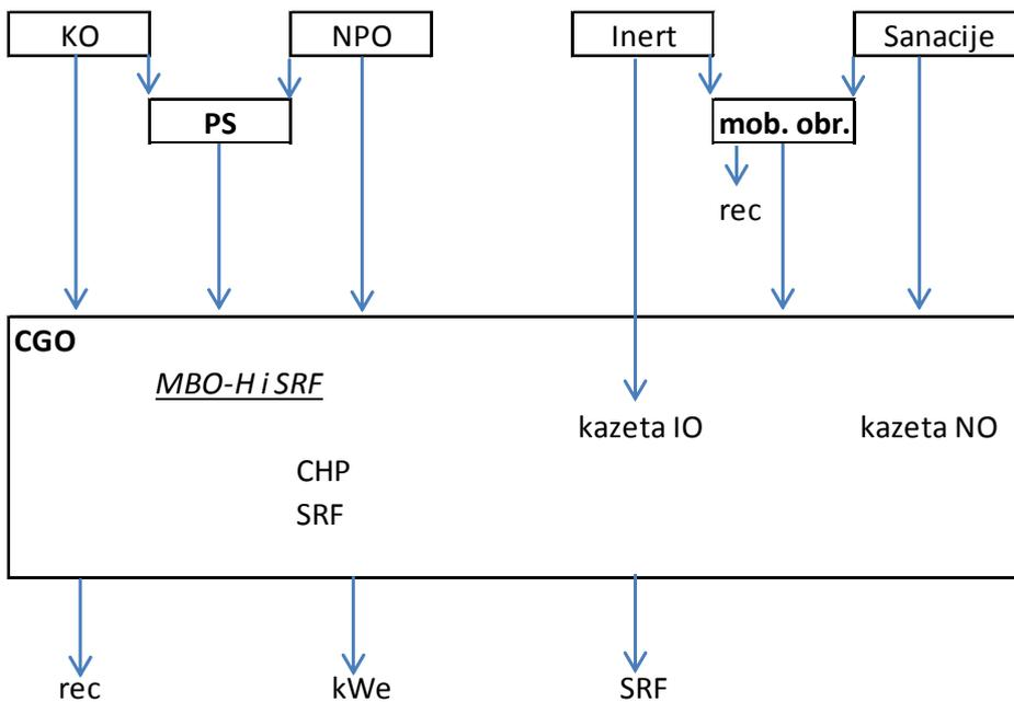
Slika 8-3. **Varijanta C**: CGO + MBO-H (hibridna: anaerobno-aerobna obrada) (IPZ, 2014)
