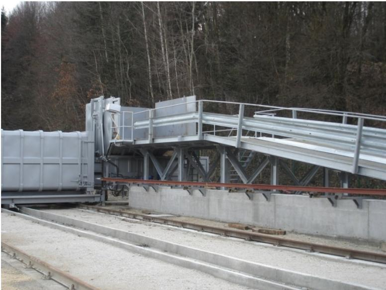
Slika 6-1. Nenatkrivena – "u pravilu natkrivena" automatska PS denivelirana u pola etaže s jednim pretovarnim mjestom s gravitacijskim unosom otpada u stacionarnu prešu i potiskom sprešanog otpada u rolo-kontejner (Hidroing, 2014)
