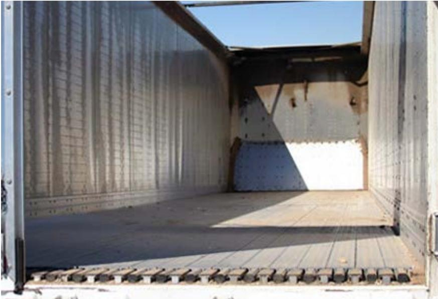
Slika 6-8. Prijevoz otpada kamionom s prikolicom (izvedba bez prešanja i istovara pomoću pokretnog poda) (IPZ, 2014)
