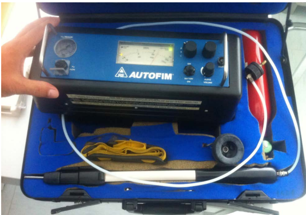
Slika 6-3. Detektor propuštanja plina "Autofim"
