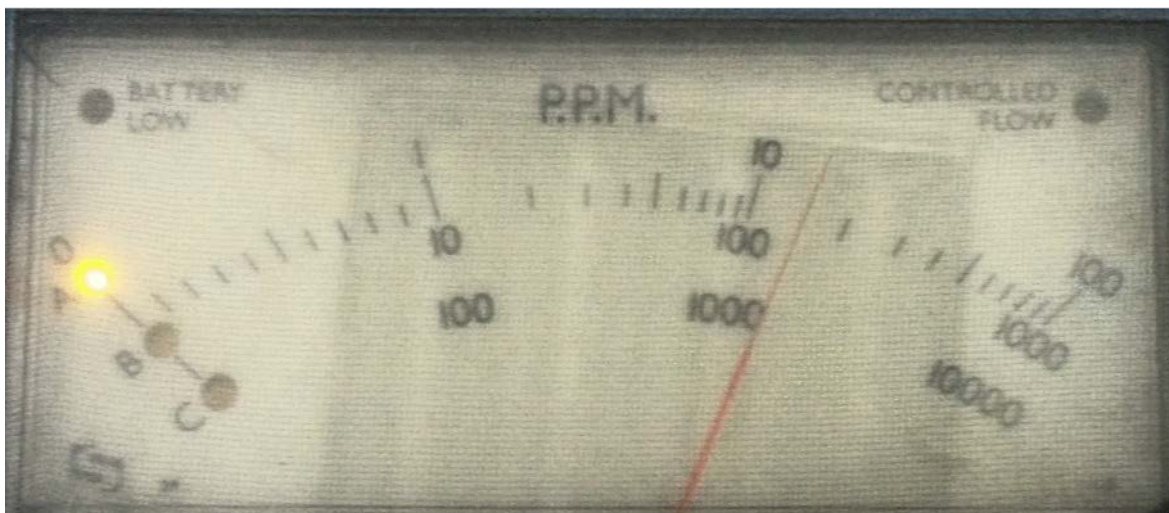
Slika 6-4. Područja osjetljivosti detektora propuštanja plina
