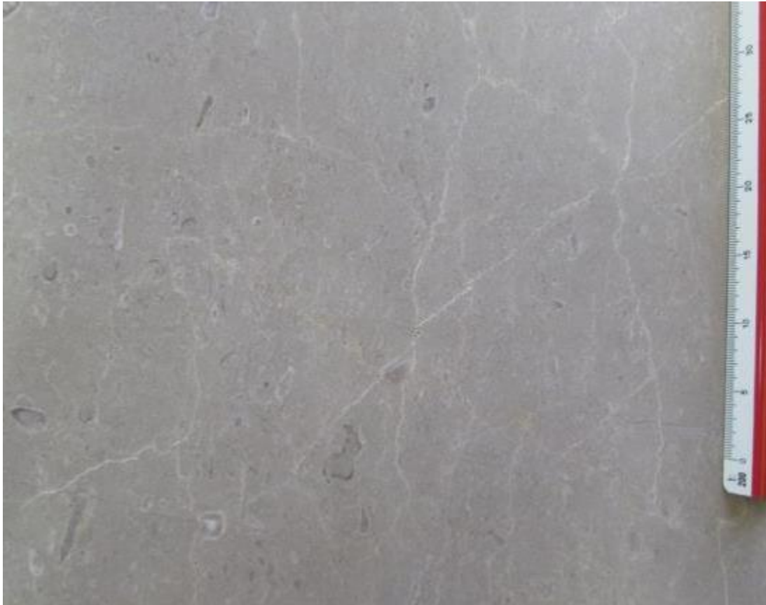
Slika 4-11. Ispolirana ploča a-g kamena „San Giovanni grigio“
