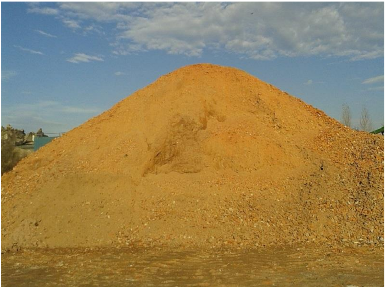
Slika 4-9. Reciklirani agregat loma opeke spreman za daljnu upotrebu
