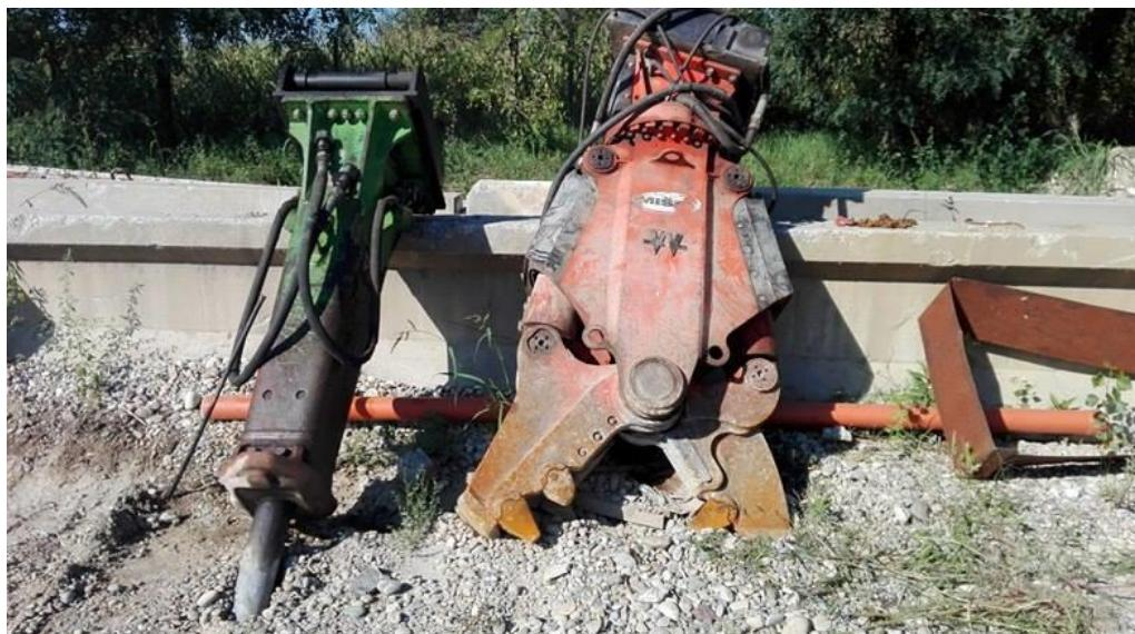
**Slika 4-6.** Hidraulički nastavci: udarni čekić i škare za rezanje
