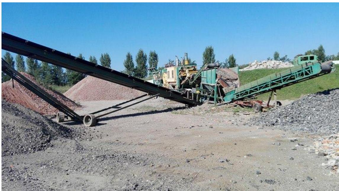
**Slika 4-10.** Drobilica i Powerscreen commander uređaj za prosijavanje
