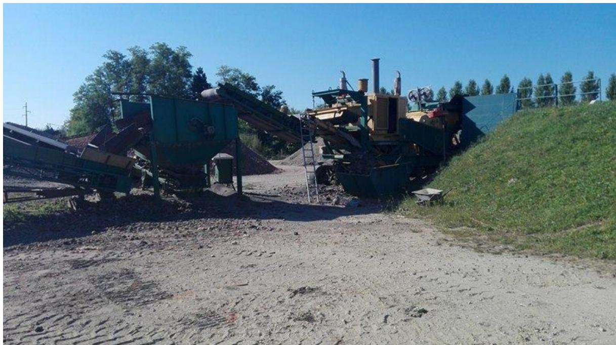
**Slika 4-8.** Pokretno postrojenje za drobljenje i vibracijsko sito „Powerscreen commander“
